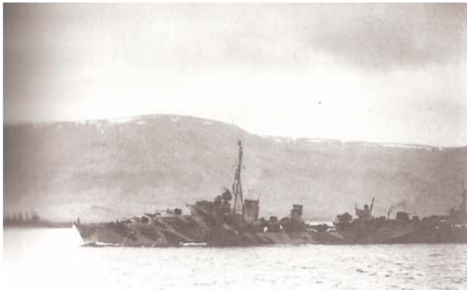
ASHANTI var en af de store moderne destroyere af TRIBAL-klassen, bevæbnet med otte 12 cm kanoner og fire 53 cm torpedoer plus luftværn.
