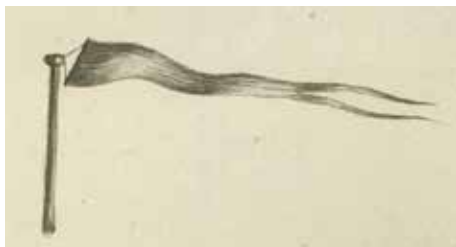
En vager, der anvendtes til søs for at undgå slid på de lange vimpler. (Afbildning fra Kofoeds Marineordbog. Handels- og Søfartsmuseet.)
