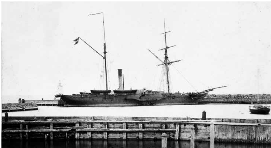
Hjuldampere HEKLA i Rønne Havn 1864. Bemærk hjulkassernes placering på siden af skibet. Skibet blev ved to togter i 1846 benyttet som kongeskib. (Orlogsmuseets arkiv)
