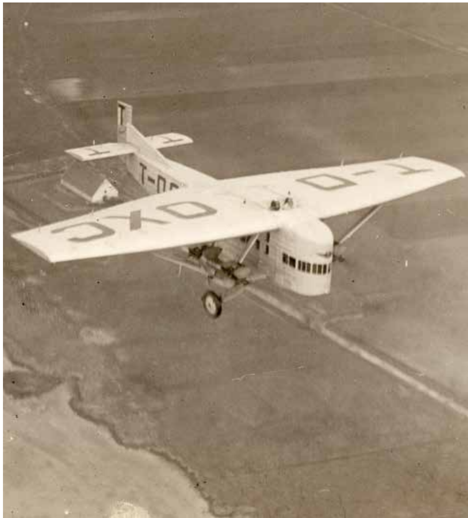
Fra glemmebogen. Farman JABIRU. 12 personers passagermaskine med fire 160/180 hk. motorer. Licensbygget på Orlogsværftets flyvemaskineværksted i 1926. (Marinens Bibliotek)
