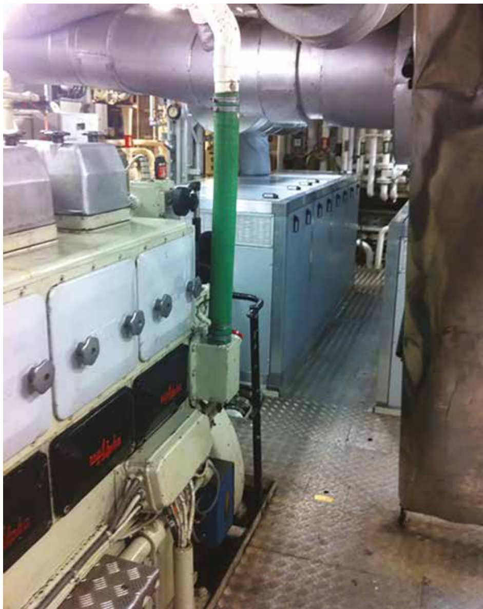
2012. Til venstre i billedet kan ses en del af den ene B&W Alpha hovedmotor, foran ses den lyddæmpende kasse med en af de nye Scania hjælpemotorer. Med hjælpemaskinerne i lyddæmpende kasser reduceres støjen i maskinrummet. (Tom Wismann)
