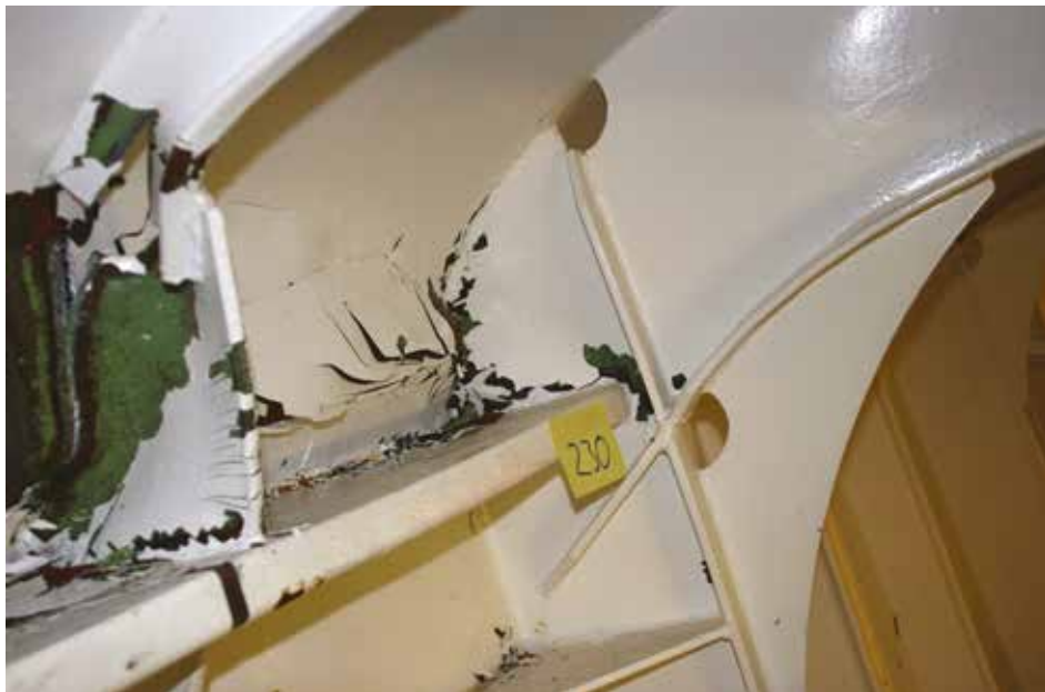
Indtrykning af spanter på HVIDBJØRNENS fordæk efter kollisionen. (Poul-Erik Larsens arkiv)
