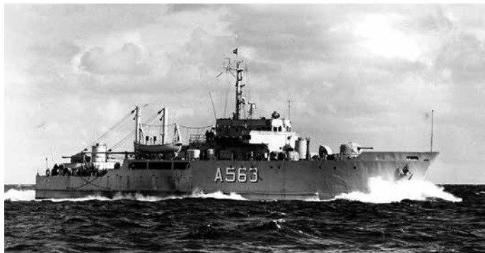
Depotskibet HJÆLPEREN var et tidligere amerikansk landgangsskib, der blev ombygget til depotskib og foræret til Danmark. (Marinens Bibliotek)
