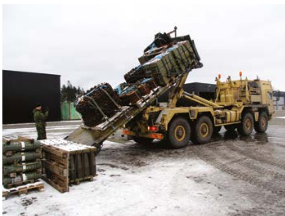
At laste 'Flatracks' kræver ekspertise. Og fast-surringen står sin prøve ved på- og aflæsning. Foto: Per B. Jørgensen
