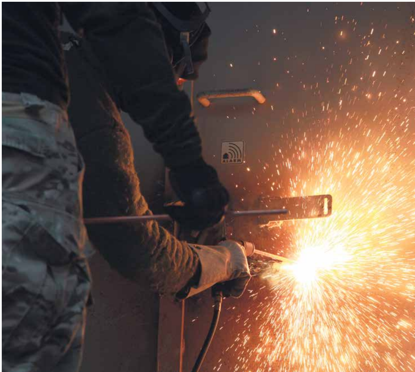
Skæreelektroden smelter jernet i den kraftige dør og blæser det smeltede materiale væk med et højt oxygentryk. Alarmen ville for længst have varslet vagtcentralen om det igangværende indbrud.
