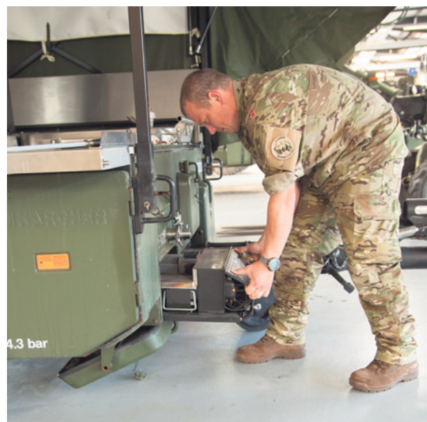
Anhængerens brænder bruger diesel, så forplejningsgruppen kan arbejde under alle forhold.
