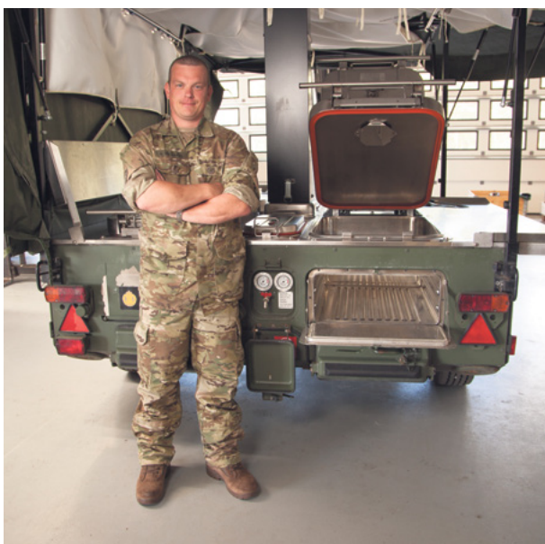
Køkkenanhænger fungerer som et stort komfur med to ovne, to kogekar og to stegeplader.
