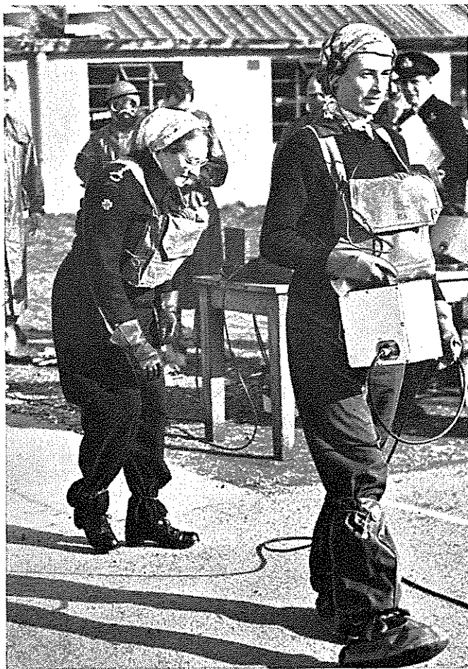
Frøken Pam Weston tilhører de britiske kvinders frivillige civilforsvars-kolonne og spadserer her af sted med en Geiger-søger, som registrerer når der er radio-aktive stråler i et område; søgeren giver nogle små klik, så snart den rammes af radio-aktive stråler, og den hjælper således redningskolonnen til at finde en sikker vej gennem et område, hvor der efter et bombardement må antages at være radio-aktiv virksomhed.
