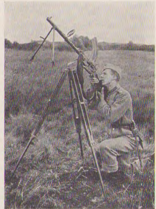
Rekylgæver i Luftværnsstativ.
