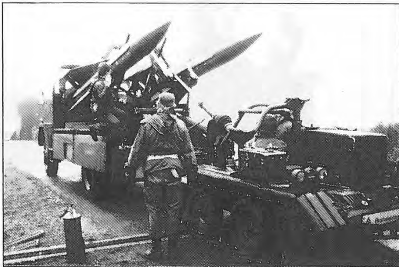
2 HAWK raketter lægges på palletbærende lastvogn i afskydningsområdet.
