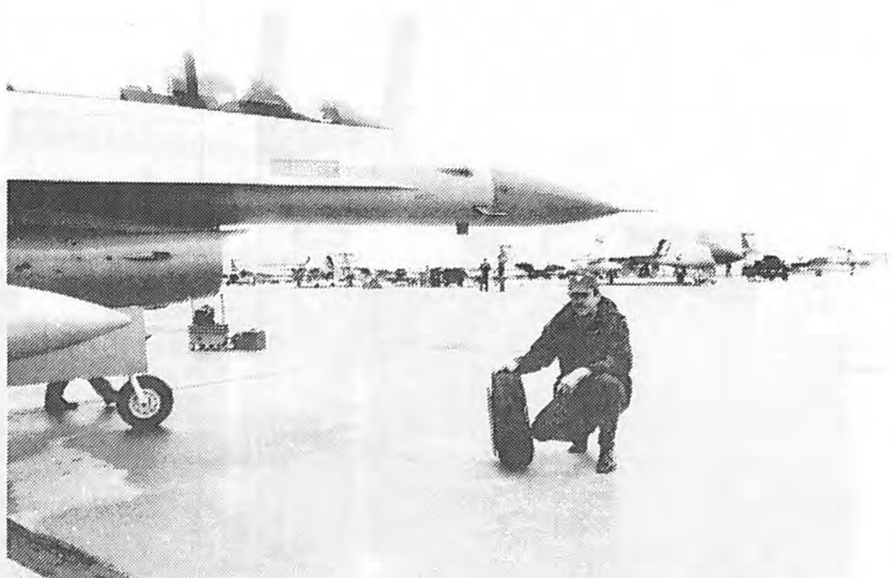
F-16, ET-614, punkterede under landingen på GOOSE BAY. Det medfølgende teknikerhold klarede hurtigt sagen. Her ses OKS S.F. Jørgensen med det beskadigede dæk.
