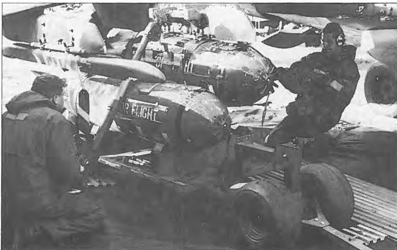
Der hænges bomber under flyet, med håndkraft. De små kraner monteres på flyets hardpoint og kan derefter hive bomberne op på plads. Simpelt, men effektivt. Vi er i felten.
