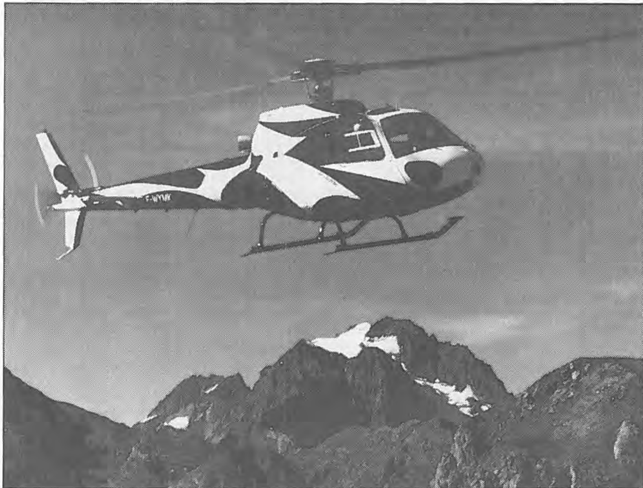
AS350 B1 Ecureuil civil udgave med lavt understel.
