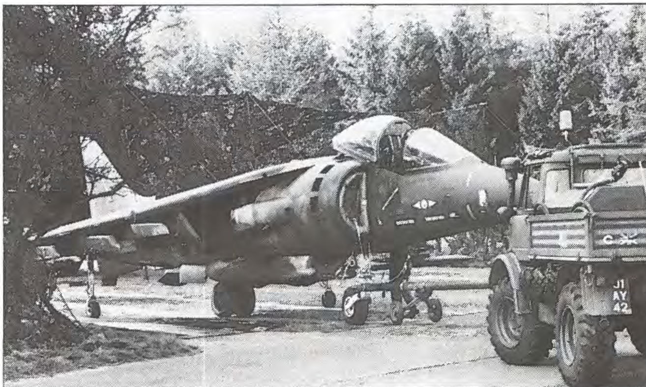
Indsugningen er sikret og flyet skubbes ind under sløringsnettet, hvor teknikerholdet står klar til at turne flyet.
