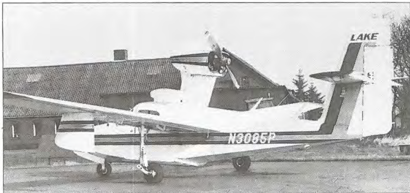
Lake Buccaneers lidt aparte anbringelse af motoren er affødt af, at vi har med en vandflyver at gøre. (foto s-n).
