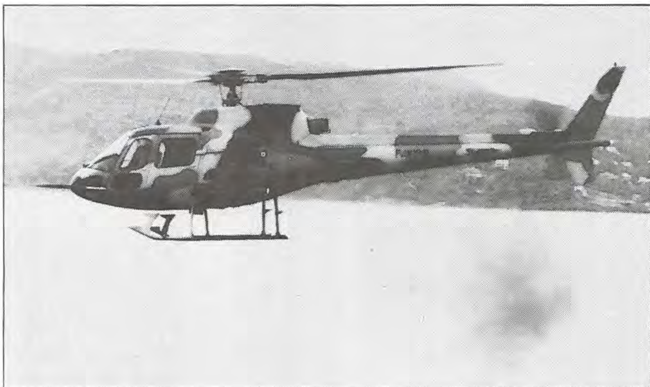
AS350 L1 en af prototyperne viser skydning med luft - jord raketter. Bemærk det høje understel.
