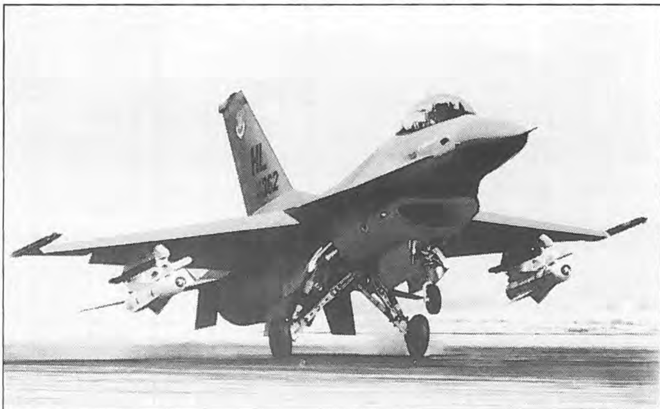
En F-16A med to TV-styrede AGM-65A Maverick missiler, der hver bæres på den nederste af de tre skinner på en LAU-88 A/A launcher.
