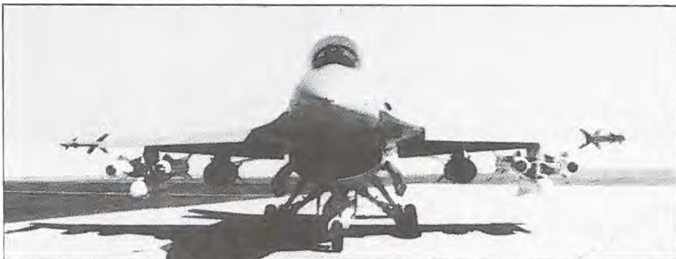
En F-16A med en blanding af TV-styrede, krigsskarpe Maverick missiler og ekscermissiler. I alt seks missiler medføres på de to LAU- 88 A/A launchers.
