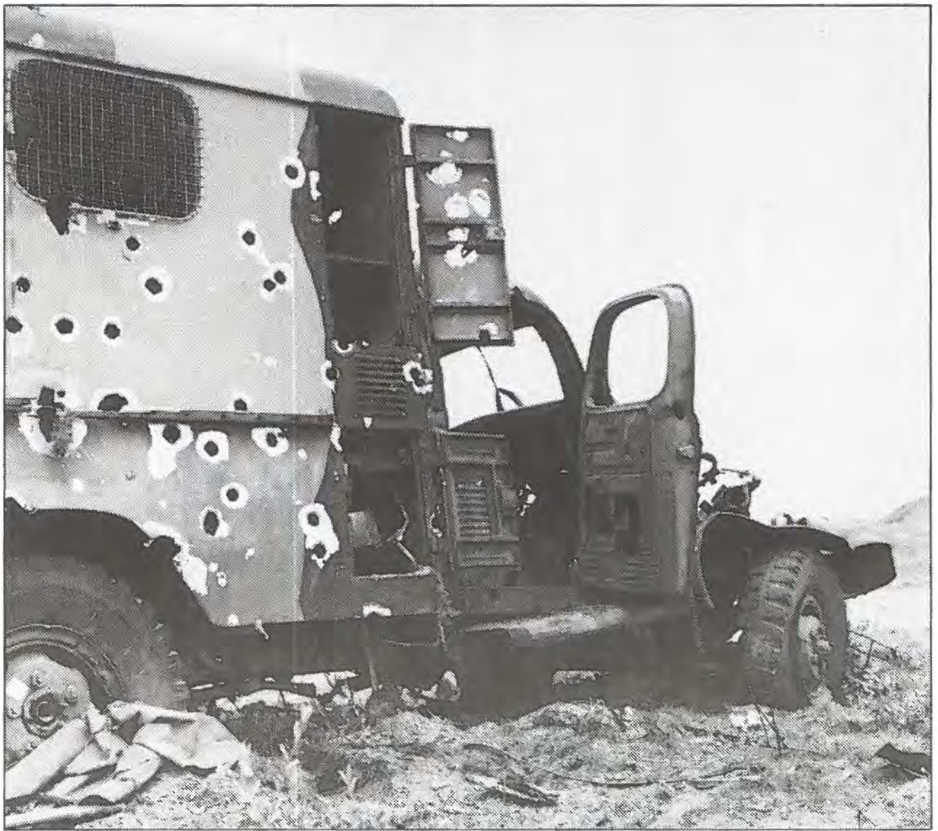
Efter nogle A-10 THUNDERBOLT angreb med VULCAN kanon og 30 mm øvelsesammunition ser resultatet således ud.
