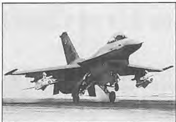
En F-16A med de to TV-styrede AGM-65A Maverick missiler, der hver bæres på den nederste af de tre skinner på en LAU- 88 A/A launcher.
