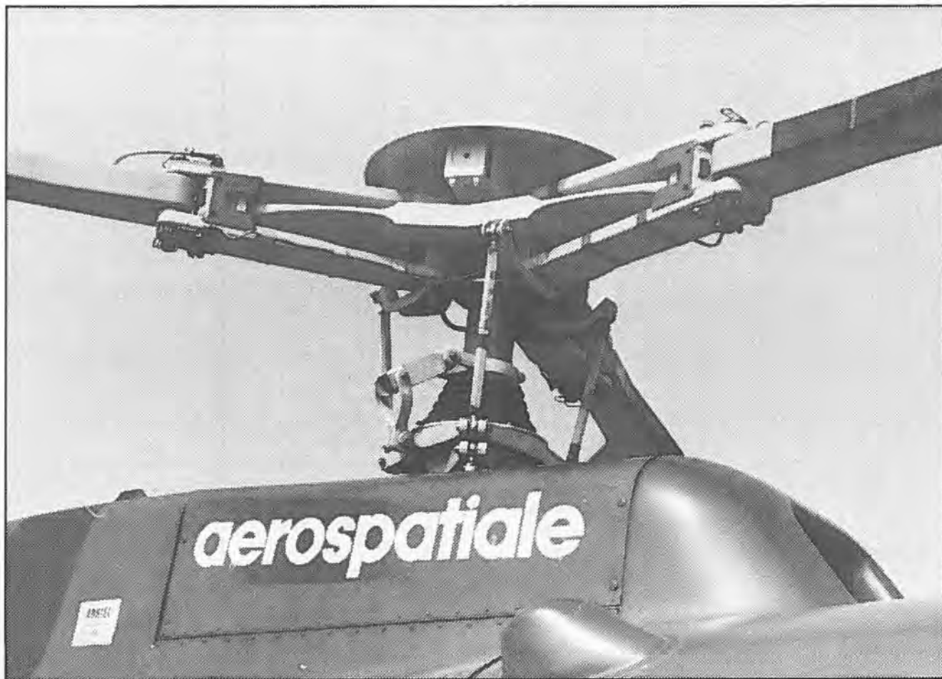
Rotorhoved og rotorblade alt sammen fremstillet af kompositmaterialer, en nyhed i forhold til de metalkonstruktioner som sidder på H-500 helikopteren.
