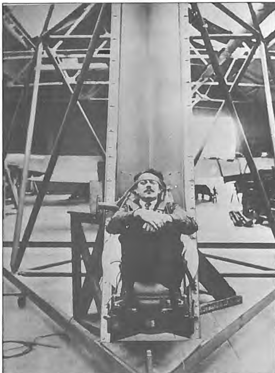
Bernard Lynch klar til endnu en prøveudskydning i den 15 fod høje testrig. (foto Martin Baker Aircraft Limited, Flyvevåbnets Historiske Samling).
