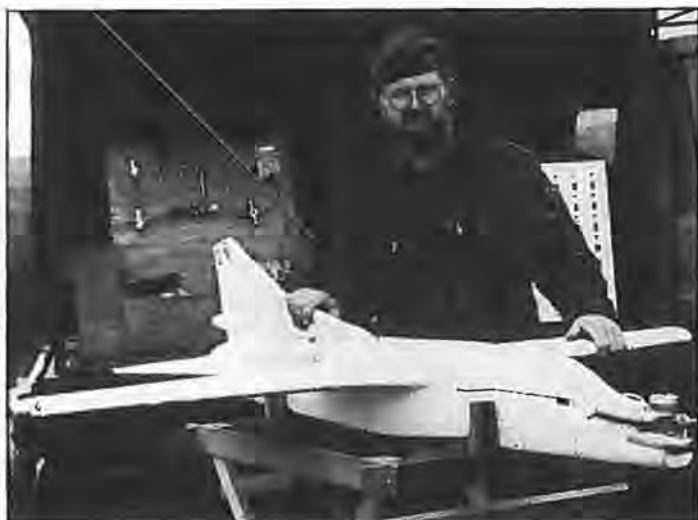
Overkonstabel af 1. grad B. Frederiksen med den minidrone M/92, FQM-117 B-1, der udgør luftmålet for Stinger missil skytterne. Den er meget bevægelig og har en størrelse og flyvehastighed, der svarer til en tiendedel af, hvad et rigtigt kampfly kan.
