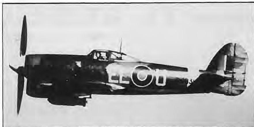
Et fly, der blev brugt med tiltværende effekt, var Hawker Typhoon. Dette fly er fra 181 Sqn og er lastet med bomber og dets fire indbyggede 20 mm Hispano maskinkanoner.
