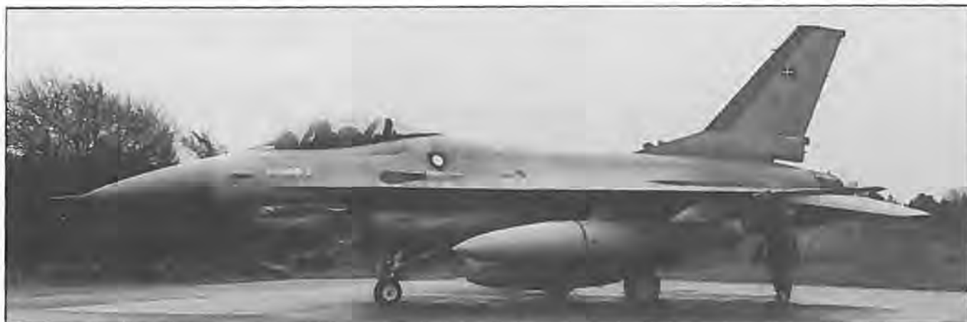
F-16 Fighting Falcon, halennummer E-108 monteret med RECCE-pod på centerliniepylon (ophæng) og 370 gallons vingetanke.
