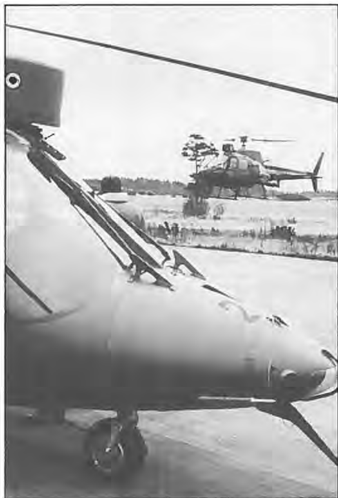
Den belgiske A 129 Agusta helikopter monteret med FLIR-sigtet. I baggrunden HFT's panserværnshelikopter Fennec, som indtil videre må nøjes med et optisk sigte. (foto s-r)
