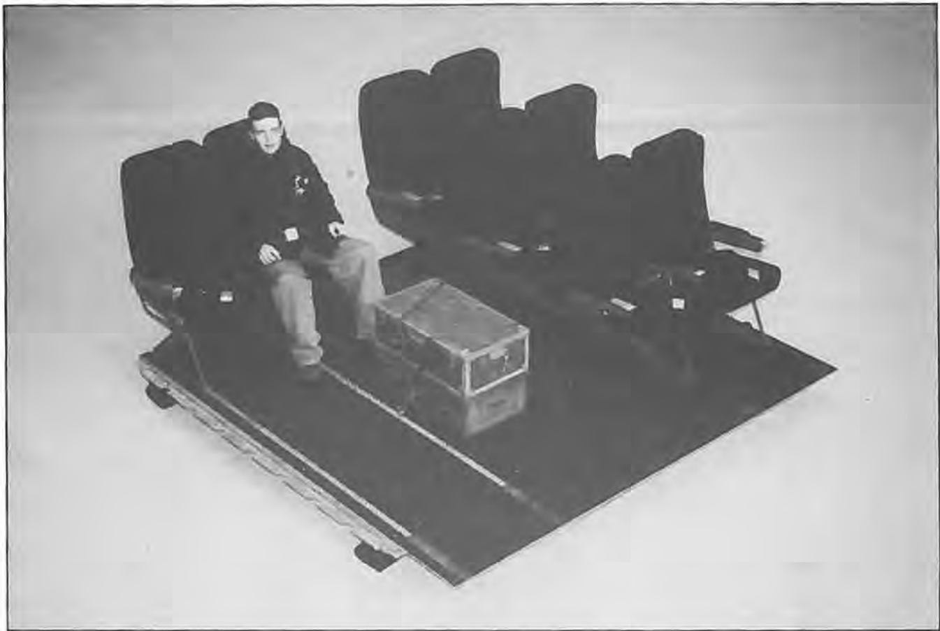
Paletten med plads til 12 passagerer har indbygget beskyttelsesplade i bunden til beskyttelse af passagererne mod beskydning med håndvåben.
