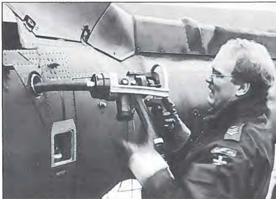
På billedet viser flyveroverkonstabel og flymekaniker J.B. Graverson, hvorledes single point head føres ned til tankstuds. Bøjlen over hans højre hånd drejes til højre og single point head er låst fast på tankstuds. Ved hans venstre hånd ses røret, som udluftningsslangen monteres på.
