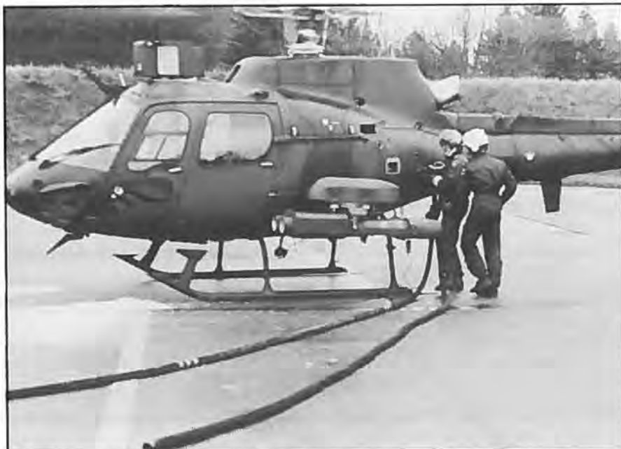
Man er nu klar til at gennemføre en Rotor Running Refuelling (RRR) på Fennec'en. Bemærk udluftningsslangen, som løber parallelt med brændstofslangen.
