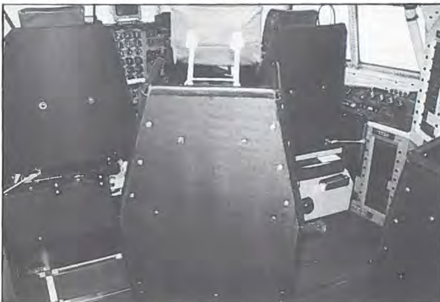
Placeringen af beskyttelsespladerne omkring besætningens sæder.
