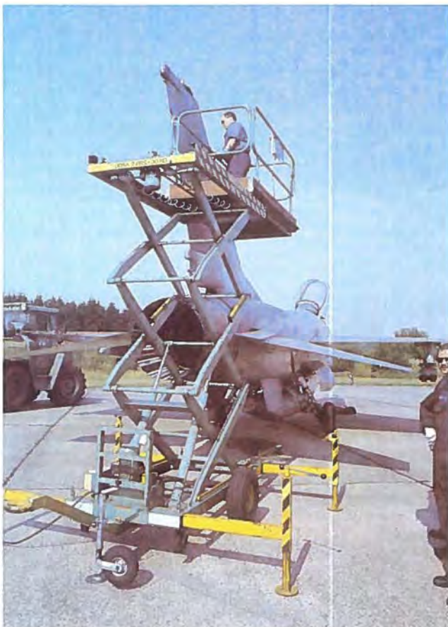
Stillets måtte der til flyveroverkonstabel S. Barjod skulle skifte antenntapen på en F-16. Den sidder trods alt fem meter over jorden. Og så er arbejdssikkerhed ikke noget man spøger med.
