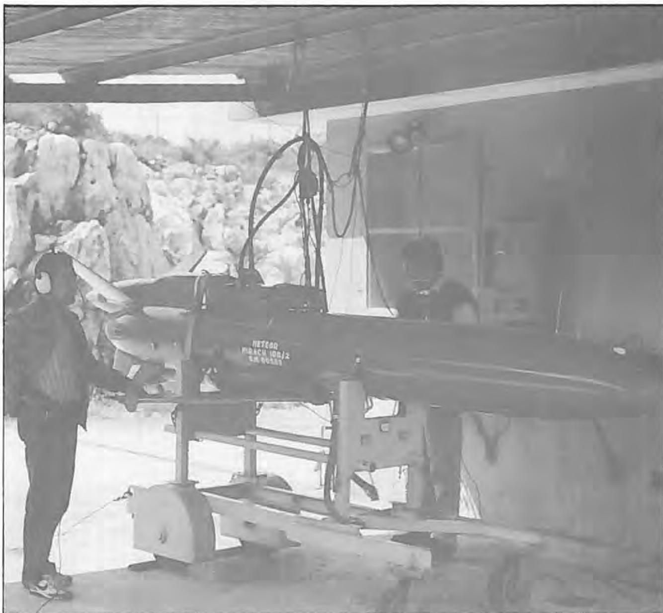
Dronen klargøres og afprøves i motorprøvestand i dagene før den skal flyve. Efter hver flyvetur lander dronen i Middelhavet med faldskærm. Den bliver samlet op med helikopter, renses og klargjort til endnu en tur.
