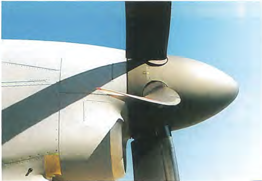
Nærbillede af den kurvede krum-sabelformede seksbladede propel, som er en af nyskabelserne på C-130J-30. (Foto RAF News).
