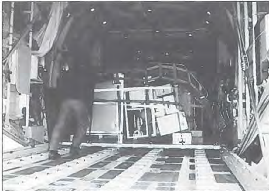
Loadmaster, seniorsergent J. Mendel-Hartvig i færd med at skubbe en pallet ind i bugen på C-130H Hercules, halenummer B-678. Bemærk venligt pladsen mellem skottet og paletten.
