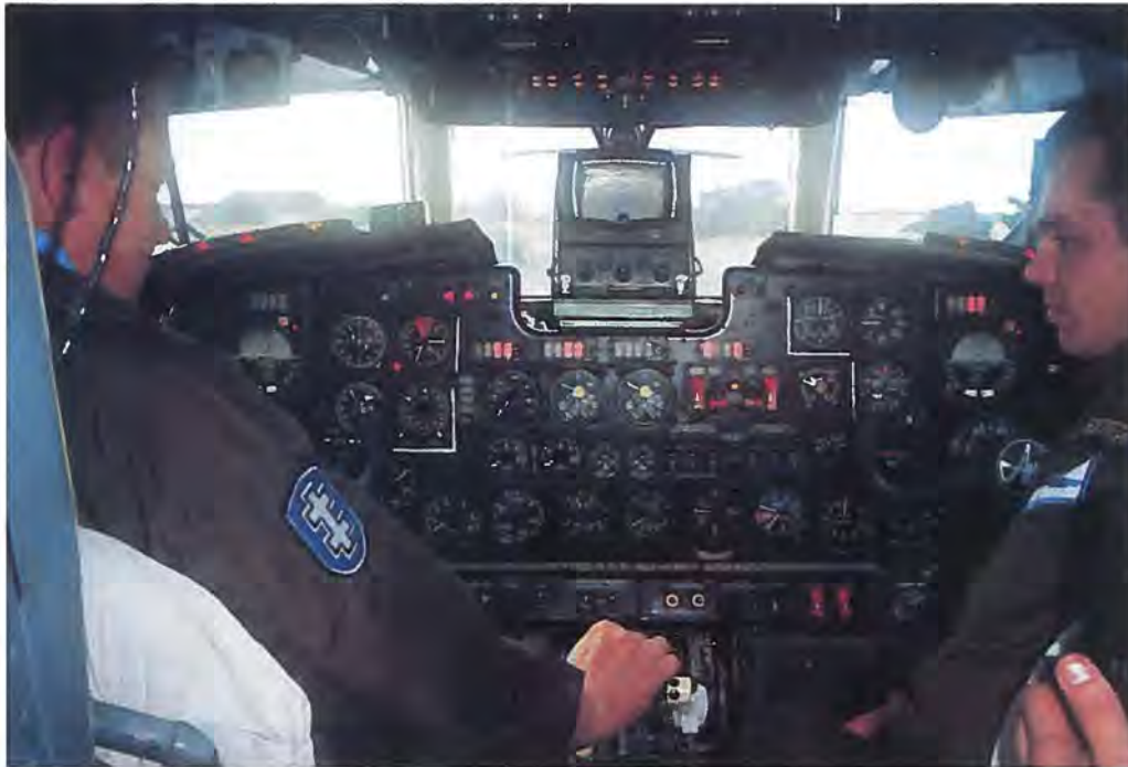
Et kig ind i det ikke særligt rummelige cockpit. Til venstre er det fartøjschefen, Saktma Vichius og til højre co-piloten løjtnant Sakshys Jury. Midt i billedet ses den radarskærm som kan bevæges 40° til begge sider.
