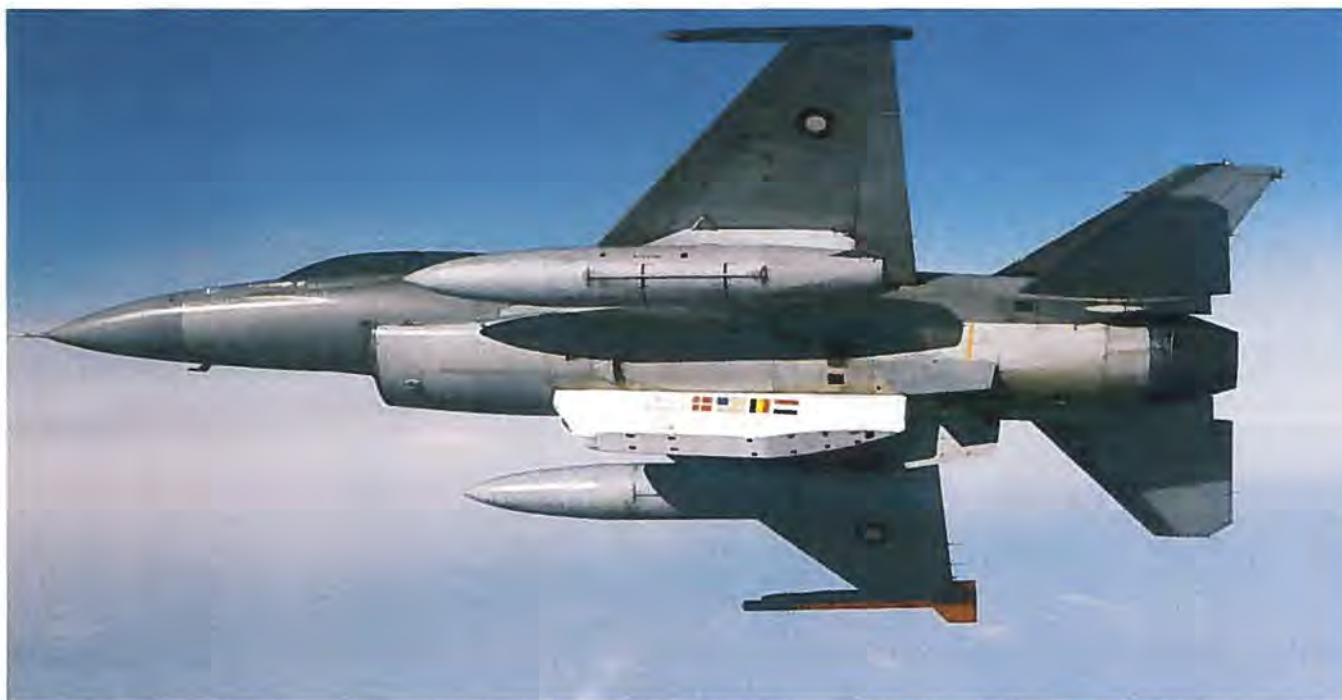
F-16 Fighting Falcon i luften med den nye fotorecognosceringspod, Modular Reconnaissance Pod, (MRP) monteret under bugen. Foto Per Udsen Co.
