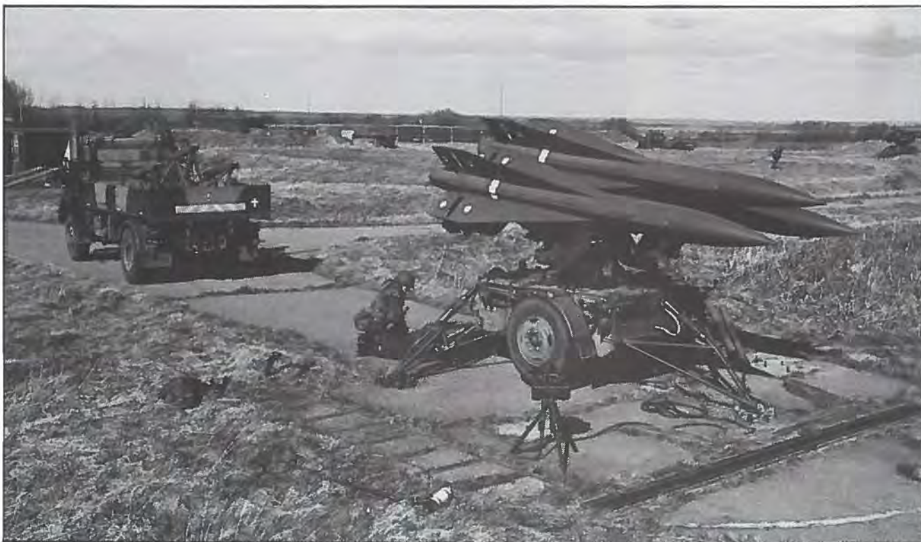
Her er man ved at knytte de sidste forbindelser fra Launcheren (affyringsrampen) og ned til kontrolvognen.
