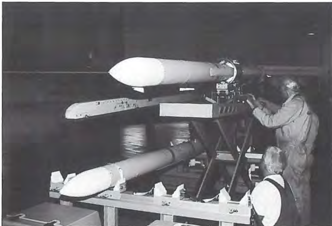
Fra åbning af Missile Test Centre hos Danish Aerotech. Her demonstreres opladning af en F-16 Fighting Falcon med et AMRAAM missil ved hjælp af en Ordnance Trolley Assembly, forkortet OTA. OTA er udviklet i Norge, men er finpudset og færdigudviklet af Danish Aerotech, som også har en aftale om at producere OTA. (Foto: Fototjenesten, Flyvestation Karup).
