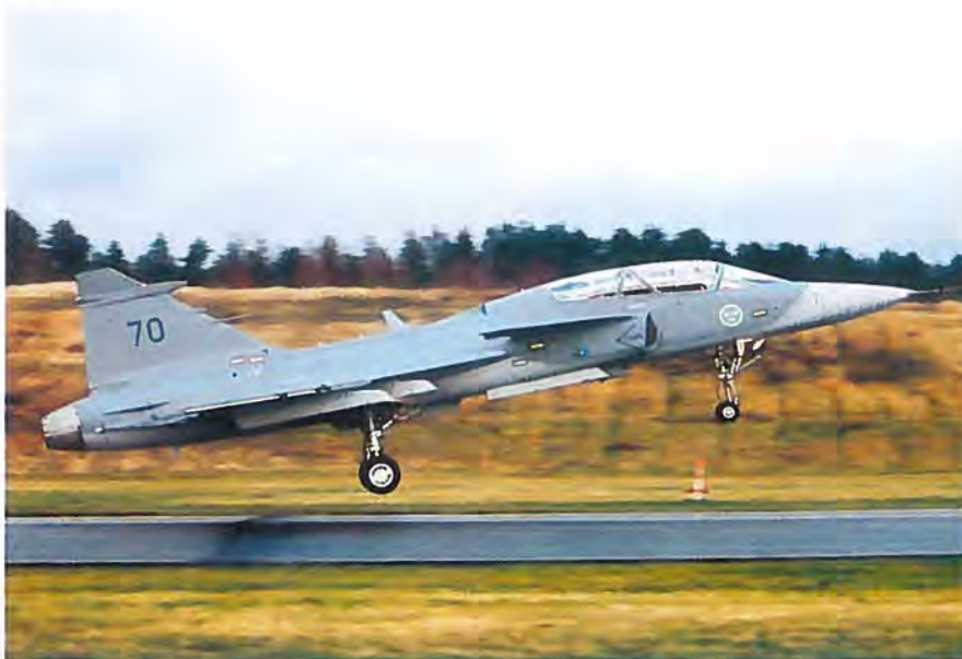
En ensædet JAS 39 Gripen armeret med AIM-9 Sidewinder Luft-til-Luft Missiler, to AGM-65 Maverick Luft-til-Jord Missiler, og en droptank under bugen. Bevæbningen er udtryk for flyets multi-rolle (fler-rolle) kapacitet. (Foto Saab, Casparsson)
