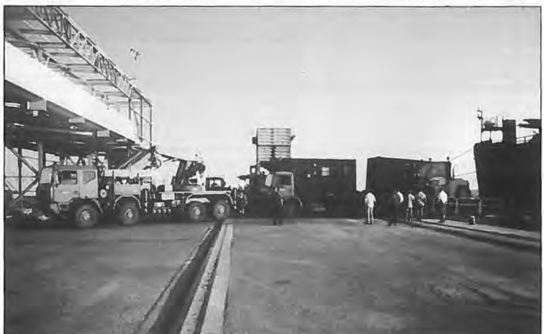
Solen står lavt. Støttebenene til en trailer har sat sig uhjælpelig fast på landgangen. Den kom fri, da den store 36 tons kran blev spændt foran.
