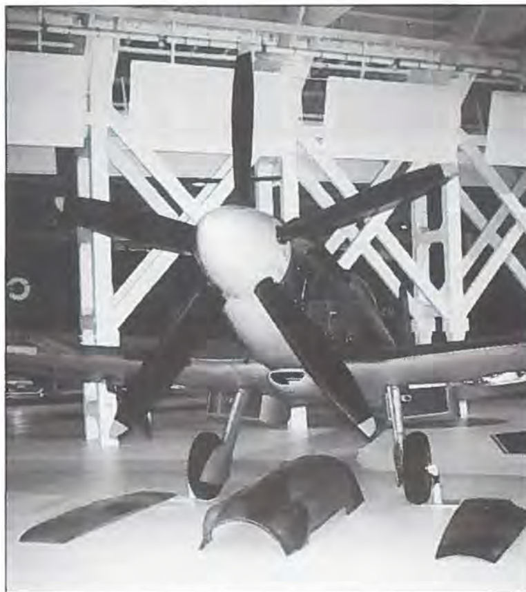
Den sidste version, der blev fremstillet af Storbritanniens mest berømte jagerfly, Supermarine Spitfire Mk. XIV havde en fem-bladede propel. Hermed havde man nået det optimale flyvehastighed, der kunne drives ud af en stempelmotor på 2.050 h.p.
