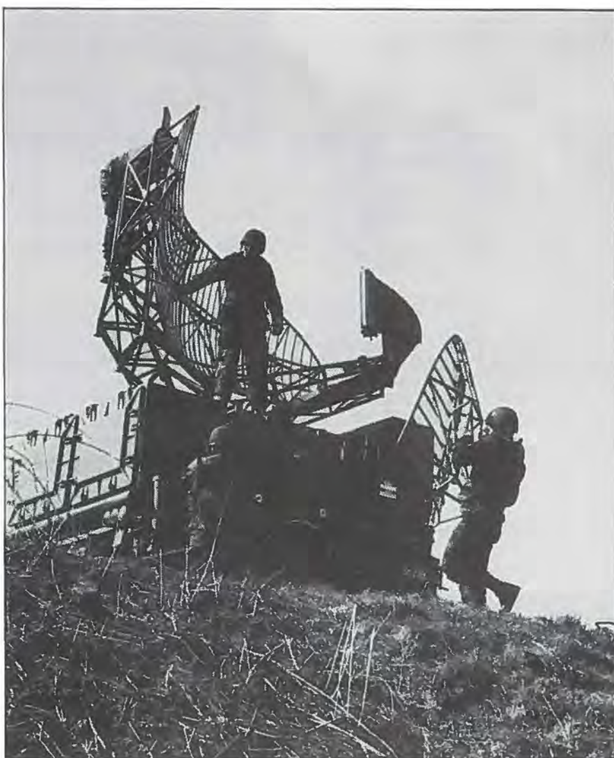
Aldrig så snart var Eskadrille 543 kørt ind i den gamle HAWK-stilling ved Hude, før personallet var i fuld sving med at montere antennen på søgeradaren. Her er der gået mindre end ti minutter efter at lastbilen er spændt fra.
