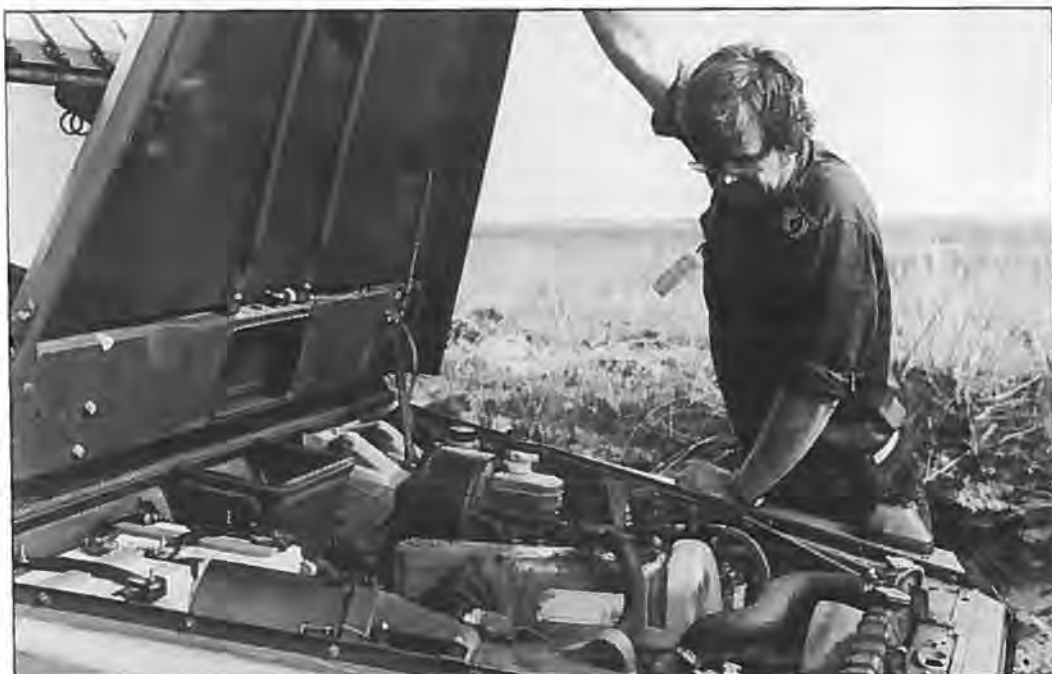
Oversergent F.E.N Christensen, fra Våbenmaterielværkstedet på Flyvestation Aalborg, og under TFW ammunitionsrydder på Kallesmærsk Hede, ser opgivende ned i GD'eren motorrum. Den vil ikke starte. Øverst tv. de én måned gamle batterier. Uden strøm. Et knækket kabel viste sig at være årsagen til miseren.
