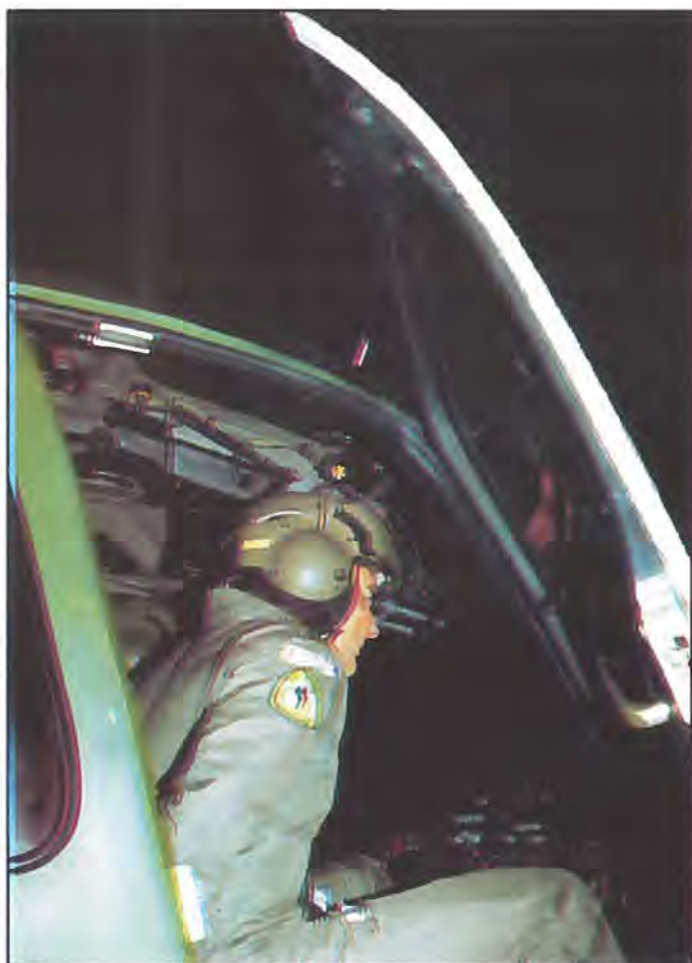
Flyverløjtnant Jan Nielsen iført hjelm påmonteret Night Vision Goggles (NVG) (nattesynskikkert). Hjelm og kikkert kan sammen med en modvægt bagerst på hjelmen veje op til 2,88 kg. Én times flyvning med NVG omregnes til 2,3 normal flyvetime. NVG-flyvning er ganske enkelt hårdt arbejde.
