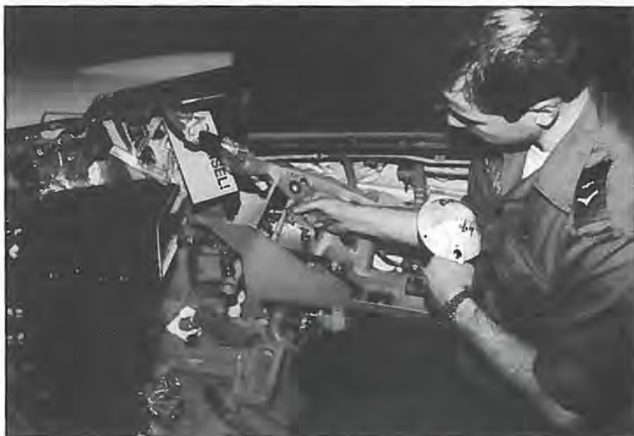
Flyverkonstabel og flyelektriker Claus Pedersen, viser en af de mange 'advarselsskilte' frem, som han har sat på, hvor et stik skal repareres eller en strømpe omkring ledningen skal skiftes ud.
