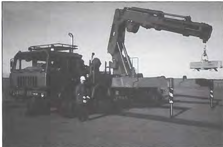
Flyvestation Karups Brand- og Redningstjenestes nye imponerende ASTRA kran, som kan løfte maksimalt 29.700 kg.
