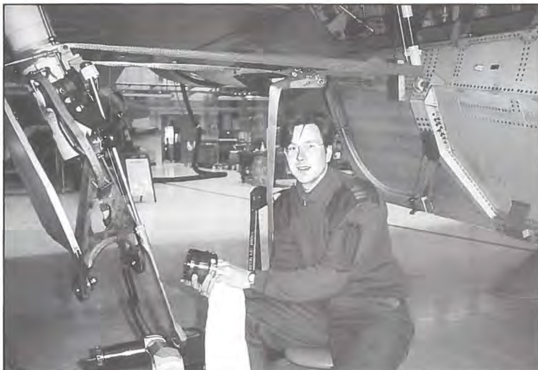
Løjtnant Ulf Nilsson ved 1. Kompagni, det der i Danmark hedder Flymaterielværkstedet, i færd med at udføre eftersyn på understellet på en Jaktviggen. Normalt ville det være foregået på et værksted på næst højere vedligeholdelsesniveau. Lige for tiden, hvor alt i Flygvapnet brydes om, er det ikke meget der er normalt. -Det er en udfordring siger han.
