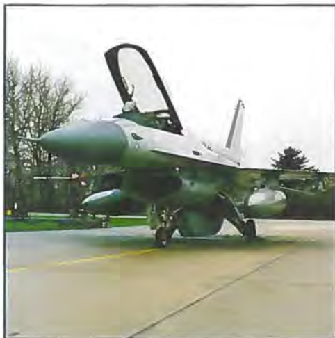
Den næsten fem meter lange fotopod, benævnt MRP Pod, fotograferet af seniorsergent Arne Hansen, Fototjenesten, Flyvestation Aalborg.
