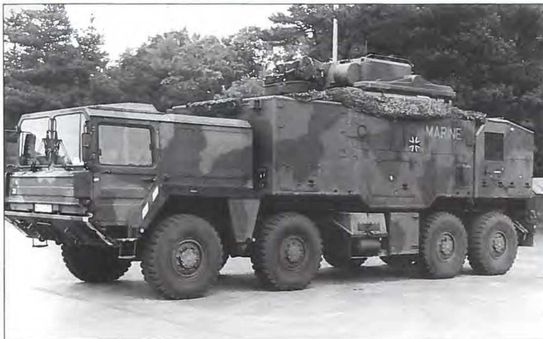
Et komplet nærluftforsvarssystem bygget ind i et køretøj og på tysk benævnt, Flugabwehr Gefechtstand ROLAND. Lidt overraskende står der MARINE på køretøjet, og det tilhører da også Naval Air Wing 2, Fliegerhorst (Flyvestation) Tarp ved Flensburg.
