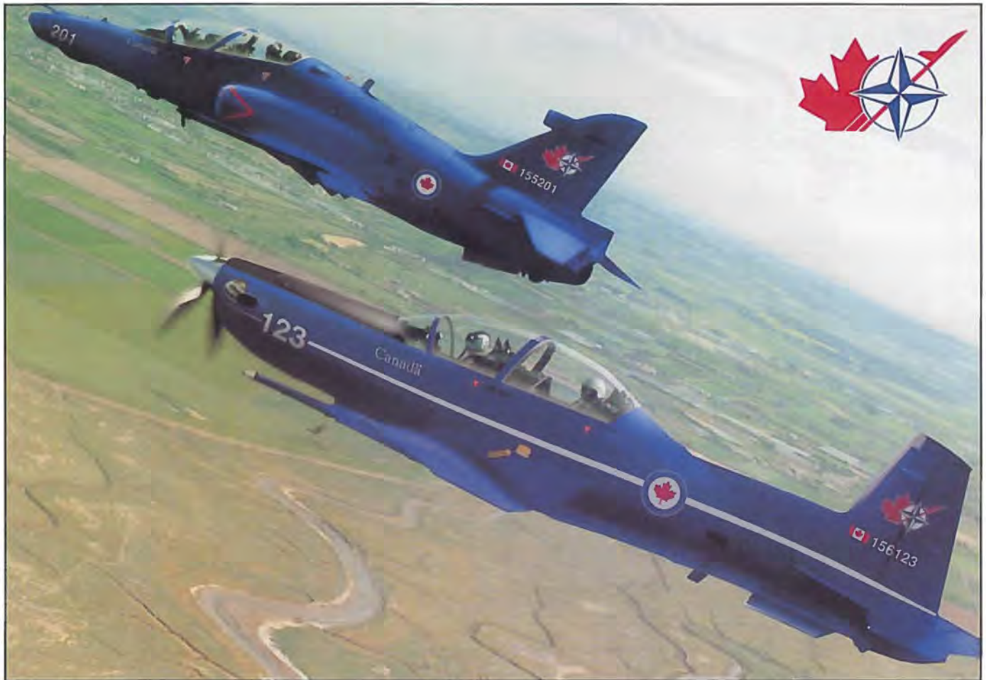
De to fly de danske flyveelever kommer til at flyve i på det nye NATO Flying Training in Canada. Nærmest er det Raytheon T-6A, i Canada benævnt CT-156 Harvard II, et tosædet turboprop træningsfly og længst væk den af British Aerospace leverede HAWK 115, tosædet avanceret jettræner med glascockpit. [foto NFTC].
