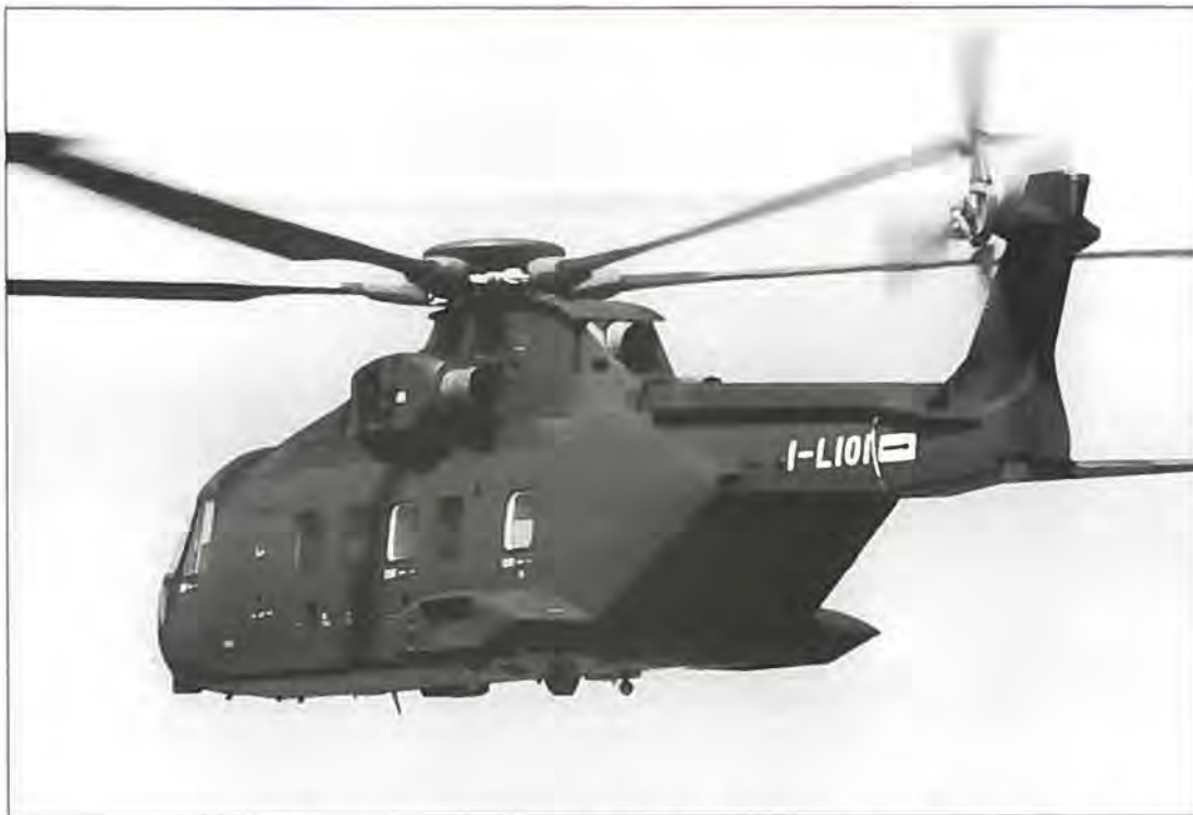
Transportversionen af EH 101 helikopteren, som kan transportere op til 30 soldater ad gangen. Rampen ude agter er 2,25 m. bred og 1,96 m. høj, det betyder, at et let køretøj kan medbringes i helikopteren, eller at en last kan ruller ind på paletter. (Foto Westland GNK).
