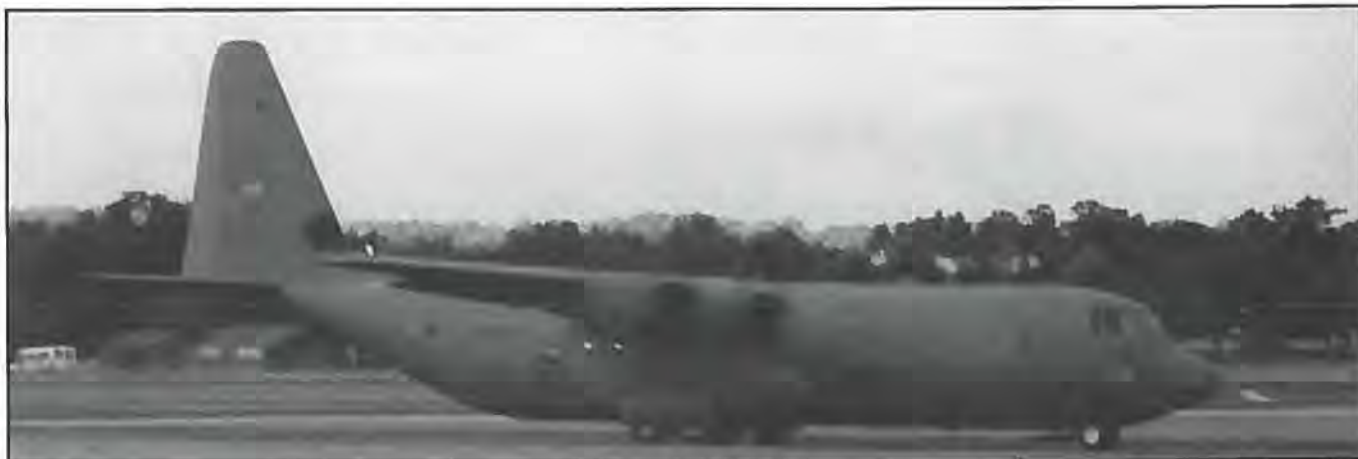
Lockheed Martins C-130J-30 Hercules. -30 betyder, at det er den forlængede version, 3,6 m skrog har man forlænget flyet med lige bag cockpittet. Ellers er mål, vægt og ydelse det samme. Flyet her er amerikansk indregistreret og fotograferet på Farnborough International '98, dagen før FAA endeligt tildelte flyet fuld luftdygtighedsbevis.
