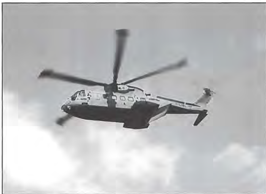
GKN Westland EH101 mellem tung helikopter, som fabrikken gerne vil sælge til blandt andet det danske forsvar. Helikopteren har tre motorer, et meget rummeligt cockpit og ikke at foragte, ståhøjde i det meste af den store kabine.
