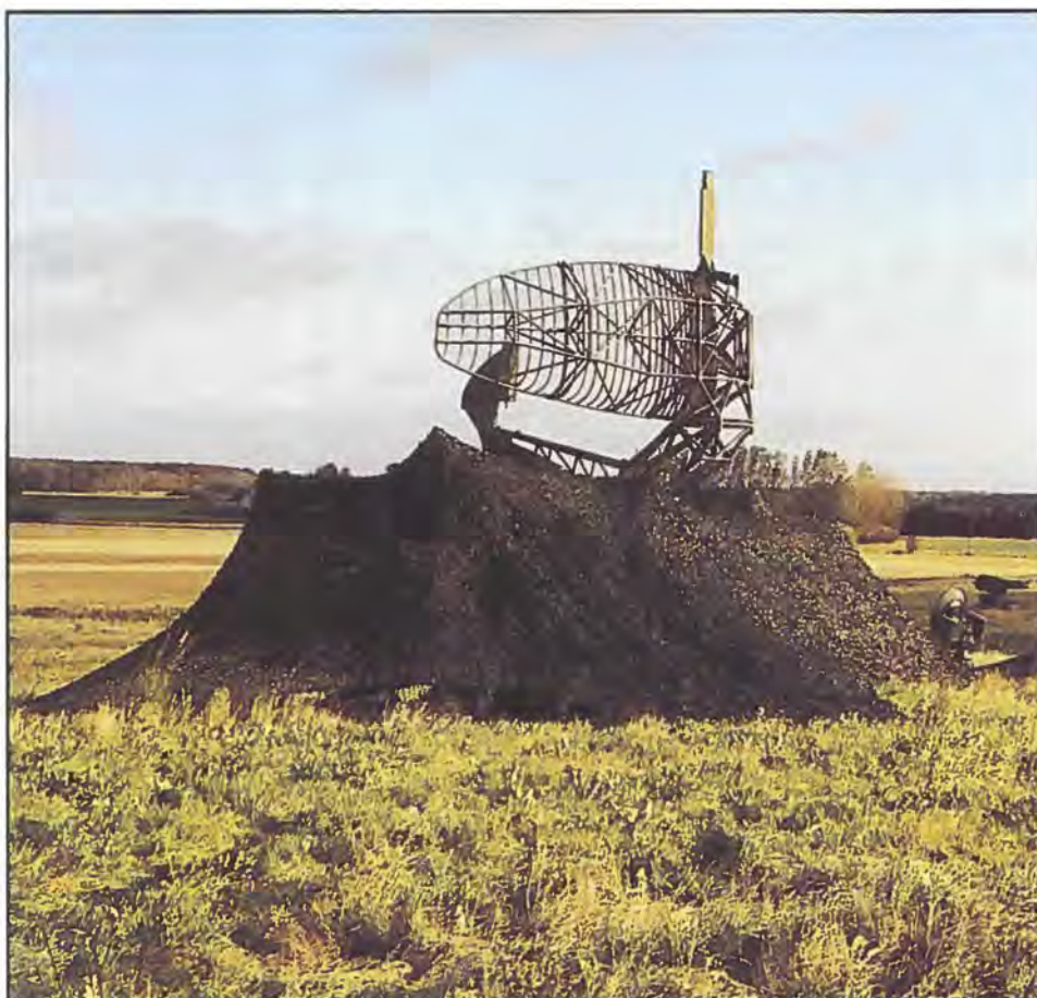
Den gamle søgeradar, der nødvendigvis må placeres i det åbne land. Her på en bakketop i billedet ses to launchere med HAWK missiler. Med indførelsen af DEHAWK, vil de kunne
