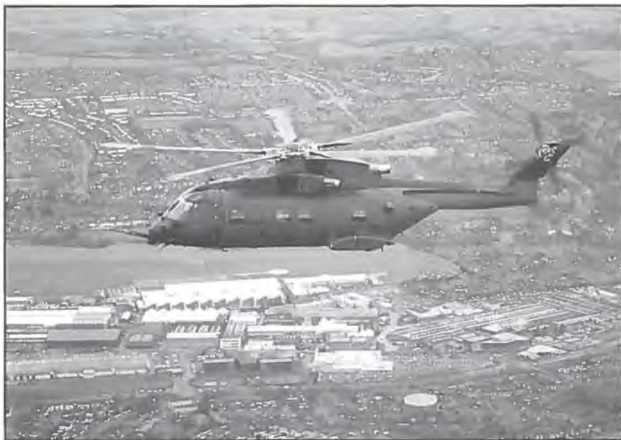
Den første serieproducerede EH101 HC Mk 3, transporthelikopter, udviklet i et samarbejde mellem GNK Westland og Agusta Helicopters, Italien, på sin jomfruflyvning over Flyvestation Yeovil, UK, den 24. december 1998. Under helikopterens næse ses den noget atypiske re-fuelling probe (påfyldningsrør).
