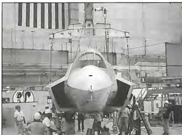
Joint Strike Fighter, som er under udvikling hos Lockheed Martin Skunk (Stinkdyr) Works i Palmdale, California, USA, er her på vej fra den skabelon den blev samlet i og ned på gulvet. Flyet er udviklet og samlet efter de mest moderne principper, som Lockheed Martin vil anvende i en eventuel fremtidig produktion.
