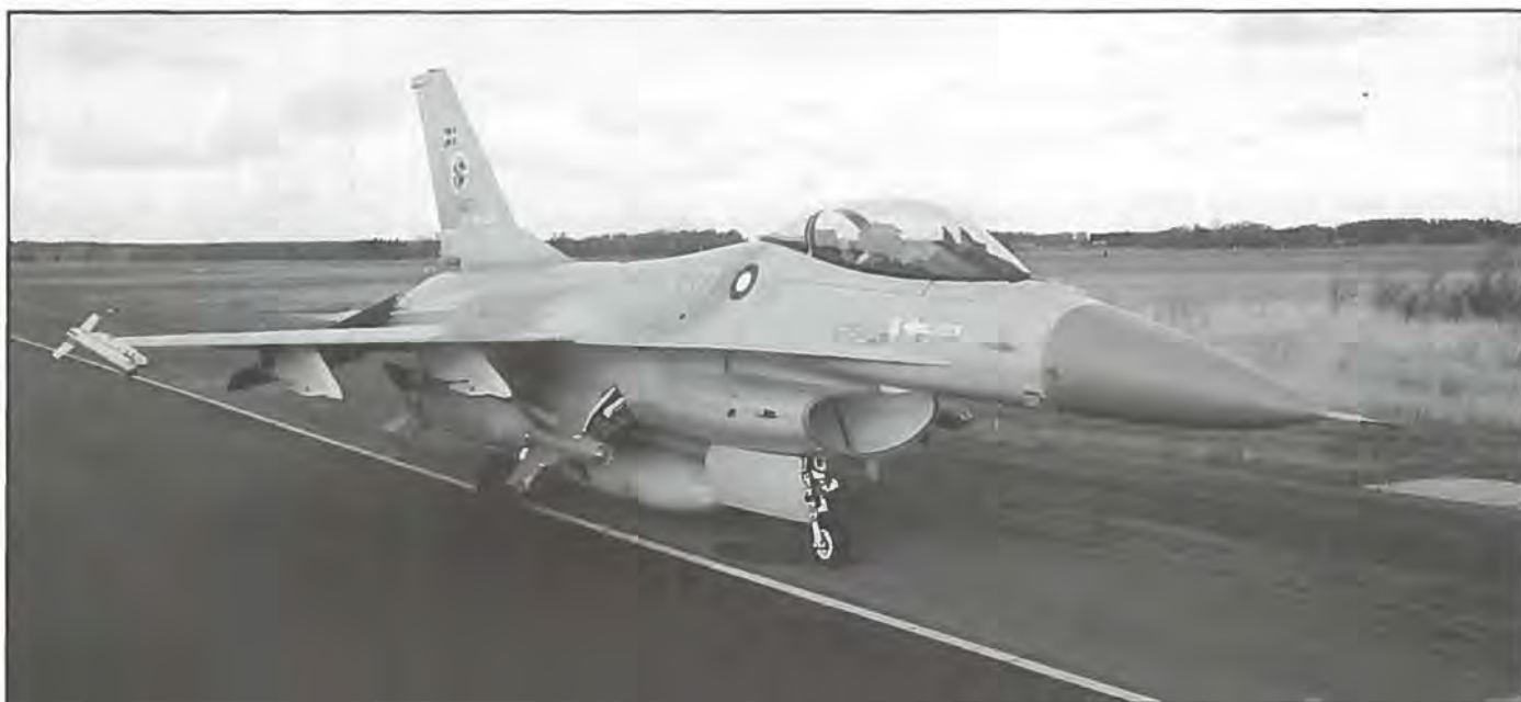
F-16A Fighting Falcon, MLU, den middel levetids opdaterede version ladet op med en laserstyret bombe og en AIM-9 Sidewinder luft-til-luft missil. (Foto: sergent H. Kristensen, Fototjenesten, Flyvestation Aalborg)
