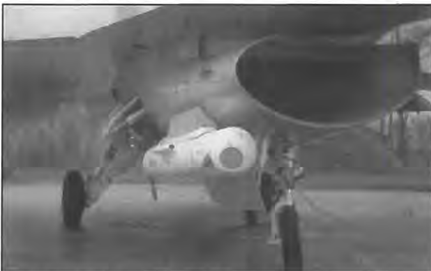
GEC-Ferranti TIALD pod monteret på højre side af indsugningen på en dansk F-16. (Foto vta FMK).
