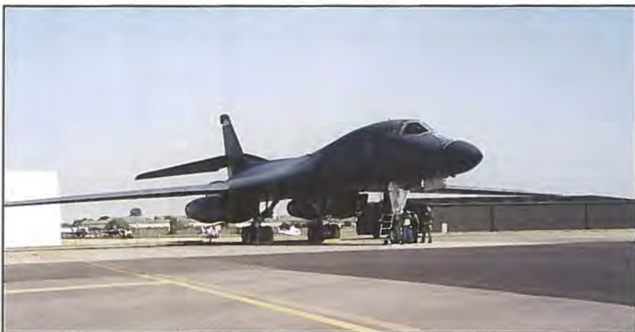
Rockwell B-1B. Et imponerende bombefly, der har en total startvægt på 216.365 kg. De mange tons kan flyve frem mod målet i 61 m. højde med en hastighed der ligger op mod lydens.
