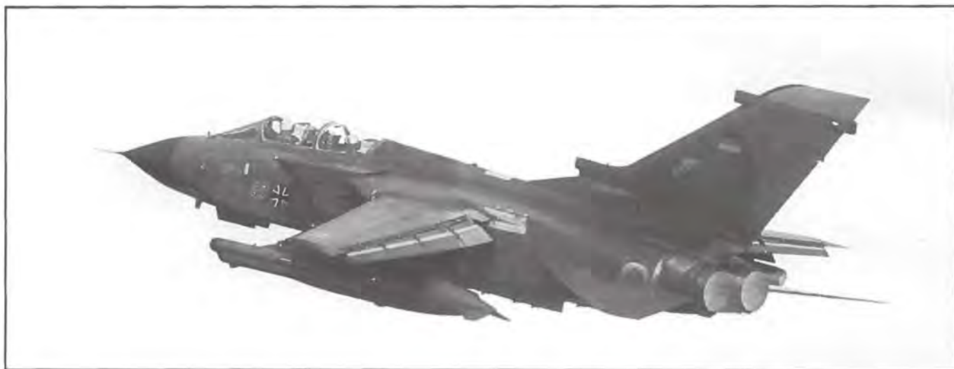
En tysk Tornado jagerbomber, som kan angribe under alle vejrforhold. Flyet er udstyret med terrænfølgeradar, hvilket betyder, at de så at sige selv kan finde frem til målet.
