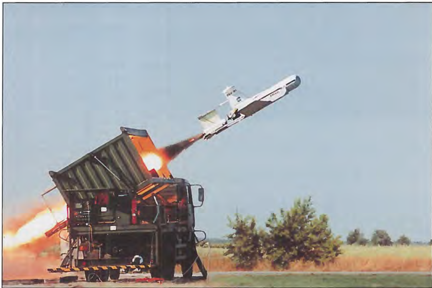
Her boosterstartes en BREVEL ubemandet observationsfly (UAV) fra sin container monteret på en fem tons lastvogn. UAV'en er udviklet af STN Atlas Elektronik GmbH, et firma i industrigruppen Rheinmetall AG, sammen med Eurodrom og Matra BAe Dynamics France S.A. Systemet er leveret til den Forbundshæren og den tyske hær den 1. april i år. (Foto STN ATLAS Elektronik GmbH)
