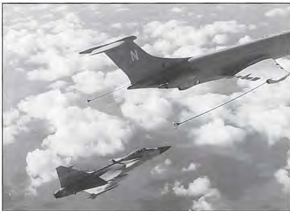
Den svenske SAAB/BAe JAS 39 Gripen på vej ind mod Royal Air Force VC-10 tankningsflyet under testflyvningen over det Irske Hav. (Foto British Aerospace, Warton UK)
