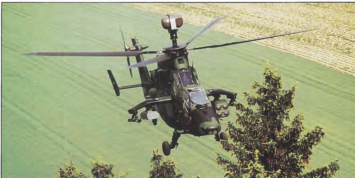
Eurocopter Tiger HAC-versionen med sigtemidlerne monteret på toppen af hovedrotoren står her på lur i dækning af træerne. HAC er den franske udgave af Tigeren. (Foto Eurocopter).
