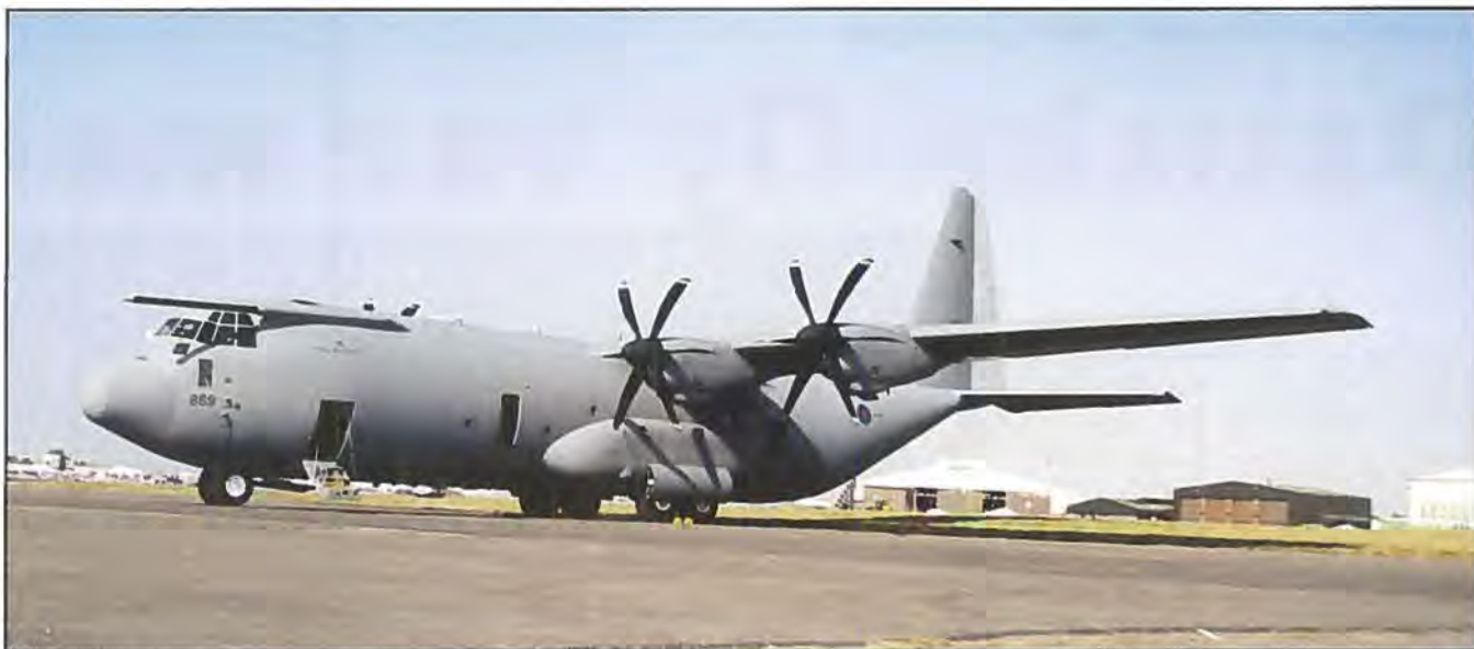
C-130J-30 Hercules, -30 betyder, at der er tale om den forlængede version, der kan medtage en større volumen af gods end den almindelige C-130J.
