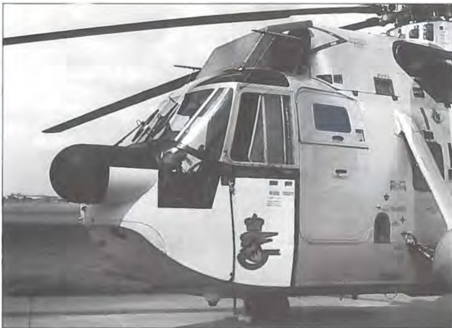
Det var med et noget forandret udseende Sikorsky S-61A kom ud af værkstedet efter at have fået en radome „syet“ på næsen i bagbords side. Billedet er taget af Fototjeneren, Flyvestation Værløse i juni måned 1977.
