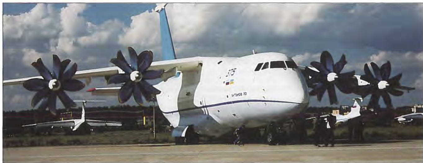
Det russisk/ukrainske bud på fremtidens store transportfly Antonov An-70, som kan flytte 47 tons gods over 1500 km. (Billede: Antonov).
