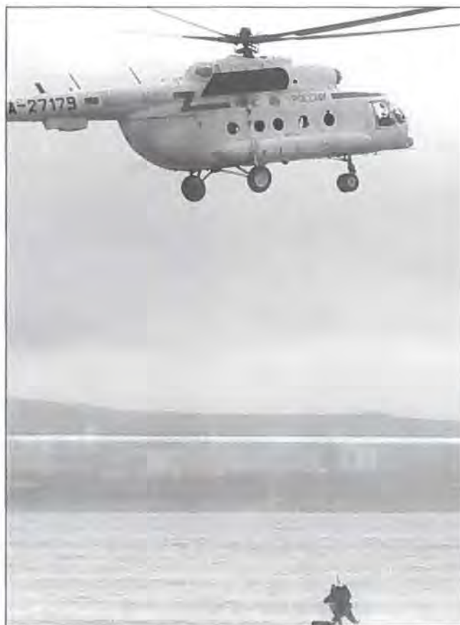
Kazan Helicopter Plants Mil Mi-17MD i eftersøgnings- og redningskonfigurationen. Den kan hente seks forulykkede 265 km. væk fra basen, og er der tale om 12 reduceres flyveafstanden til 195 km. (Foto Kazan Helicopter Plants)
