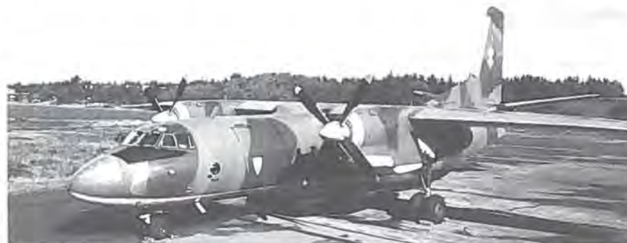
Det Litauiske Flyvevåbens største transportfly, en russisk bygget An-26. Flyet kan medtage 40 passagerer eller 5,5 t gods. Helikopteren kan medtage 30 passagerer eller tre tons gods.
