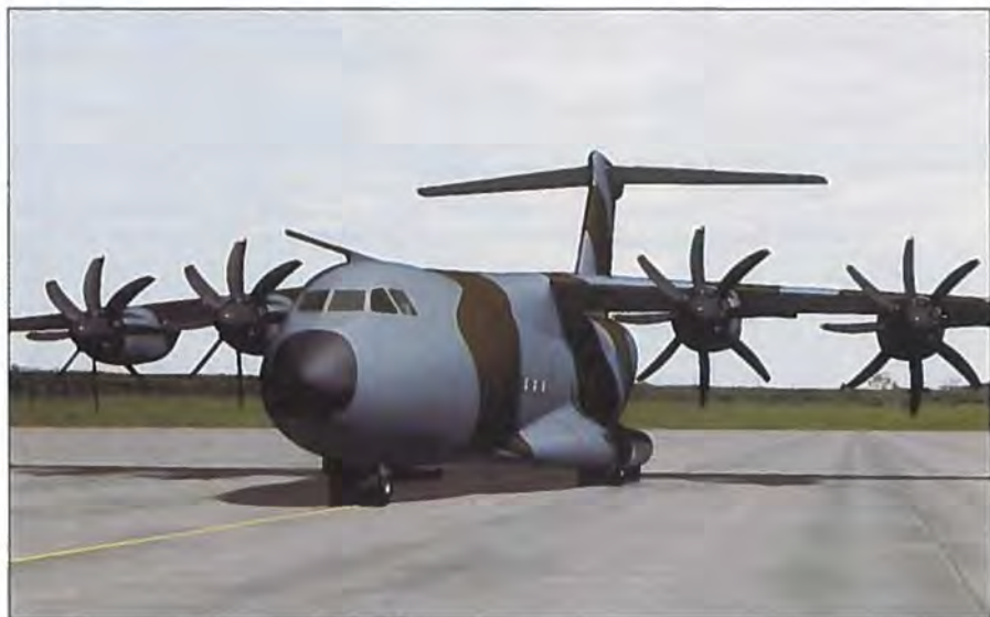
Således ser Future Large Aircraft - Fremtidens Store Transportfly - ud når computeren har tegnet den. Bliver flyet nogensinde til virkelighed har man besluttet, at det skal kunne flytte 35 tons gods over 3.900 km. (Billede: Airbus Military Company),
