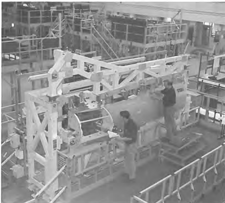
Højre forende af flykroppen til en Eurofighter 2000 under konstruktion hos BAE SYSTEM i Salmesbury.
