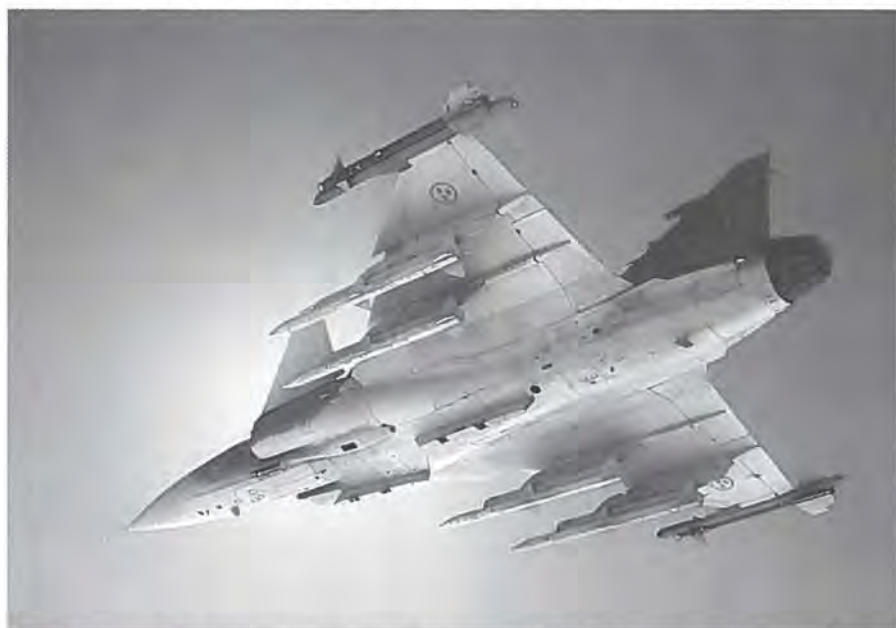
JAS39 Gripen bevæbnet med AMRAAM, avanceret luft-til-luft missil med mellem-lang rækkevidde.
