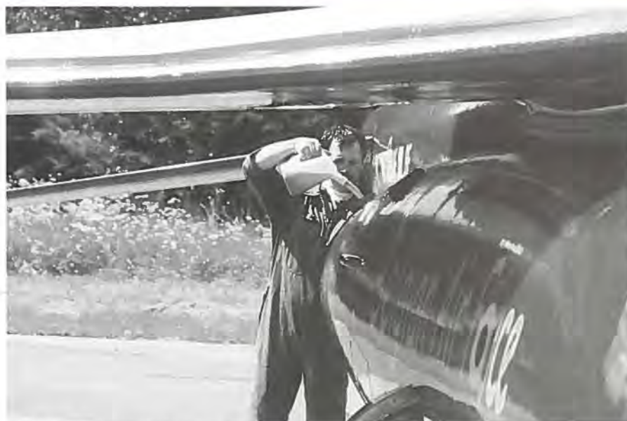
Nej, den belgiske tekniker er ikke ved at tanke sin Alpha Jet med kande. Det han hælder i er motorolie, som skal være med til at producere røg under flyveopvisningen.
