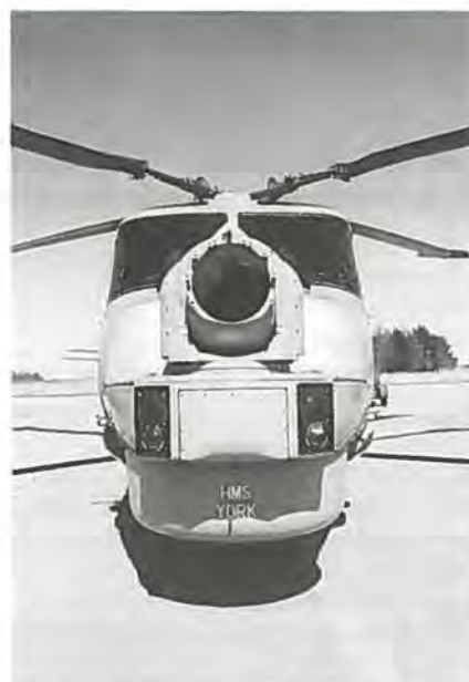
En Royal Navy Lynx, til dagligt hjemmehørende på Her Majesty's Ship York. Inde bag den runde glasrude gemmer sig de sensorer, som helikopterens besætning bruger til at sigte med, når et overfladeskib skal sænkes.
