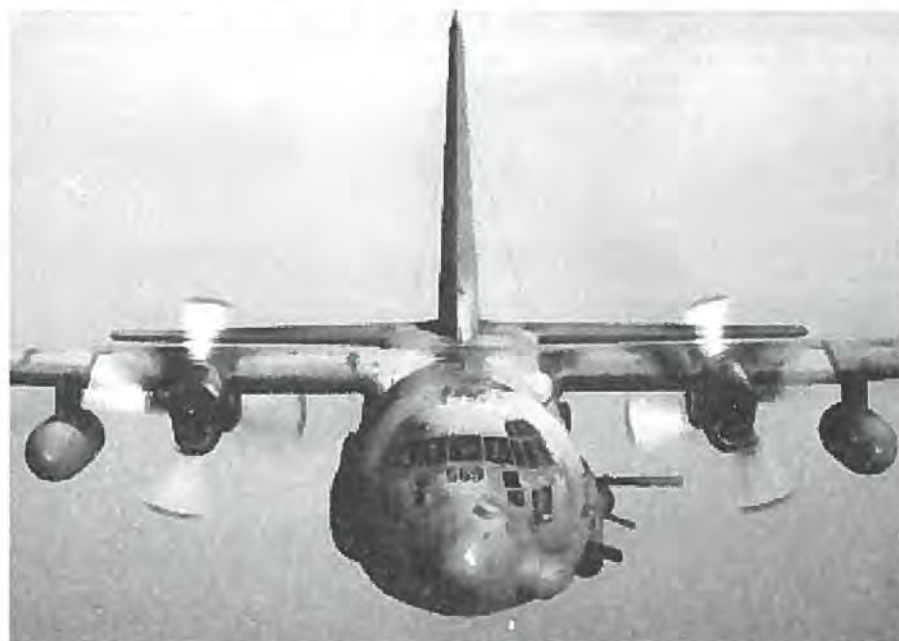
AC-130 Hercules bagerst ses kanonløbet til 105 mm kanonen, foran denne en 40 mm kanonen og endelig forrest en 27 mm Gatling maskinkanon. (Billede Lockheed Martin).
