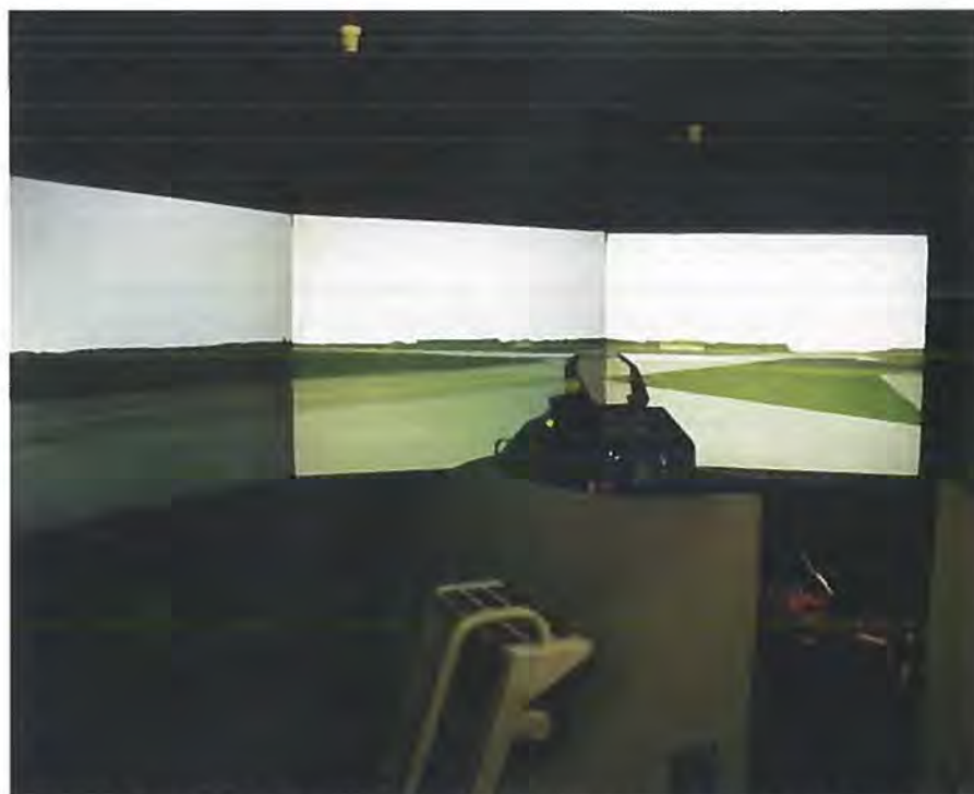
Den nye simulator har et 120° view fra det åbne cockpit. Det giver piloten en meget bedre fornemmelse af virkelig at flyve. Står man ved siden af, får man næsten følelse af at flyve med. Ikke mindst når man flyver gennem en norsk fjord med 425 knob (787 km/t.).
