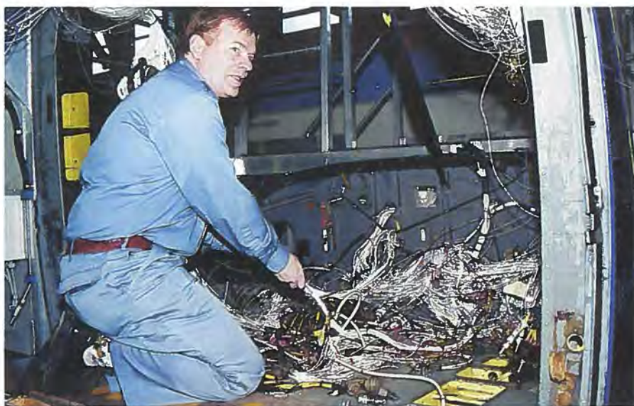
Flyelektriker Jan Weber Madsen med de ledningsbundter, der er det eneste der er tilbage i skroget på halenummer S-181.
