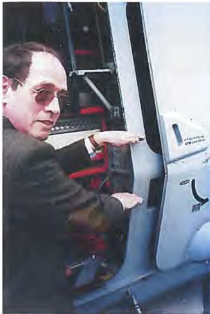
Direktøren for NH90 programmet, Gilles Dufour viser, hvor man har tænkt sig at bygge de 25 cm ind i helikopteren for at skabe ståhøjde i kabinen.
