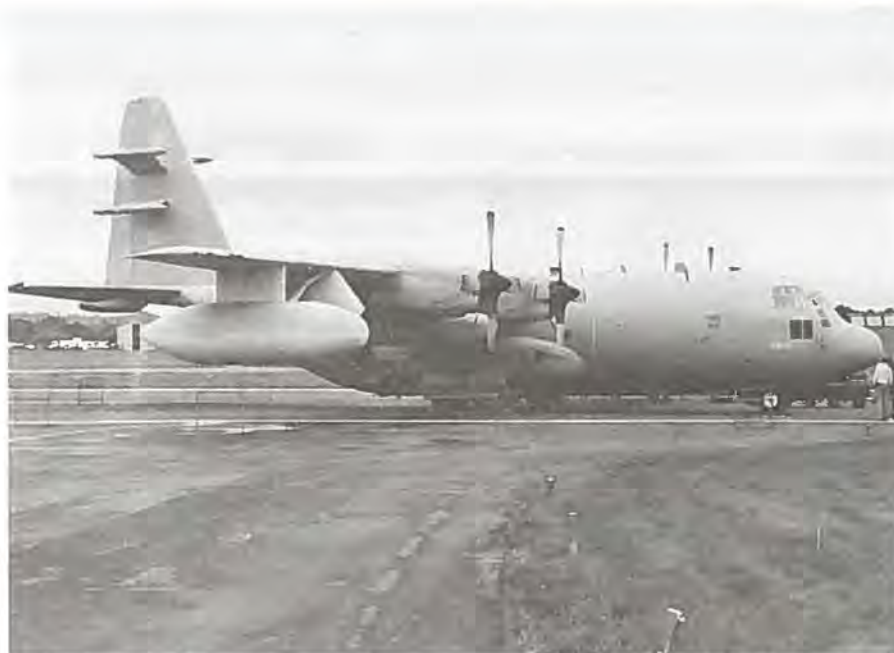
Denne EC-130E tilhører Air National Guard 193rd Special Operation Wing med hjembase på Harrisburg International Airport, Middletown Pennsylvania, USA. Flyet er spækket med elektronisk udstyr og antenner. Det er kort sagt en flyvende radio- og TV-sendestation, der anvendes i propagandaens og efterretningens tjeneste. (Billede s-n).
