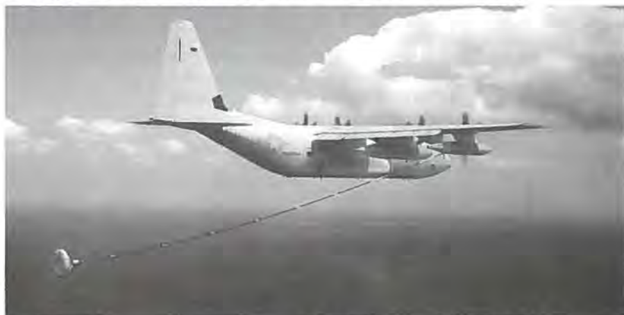
Lockheed Martins seneste levering til US Marine Corps, en KC-135-J Hercules Tanker, som kan tanke både fastvingede hurtige fly og helikoptere.
