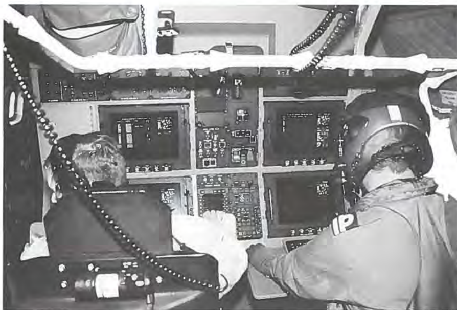
I kabinen sidder dette konsol, hvorfra operatøren styrer eftersøgningen af skibe både på og under vandoverfladen. Royal Navy er meget tilfreds med de forbedrede sensorer, man har fået til at jage ubåde og overfladeskibe med.
