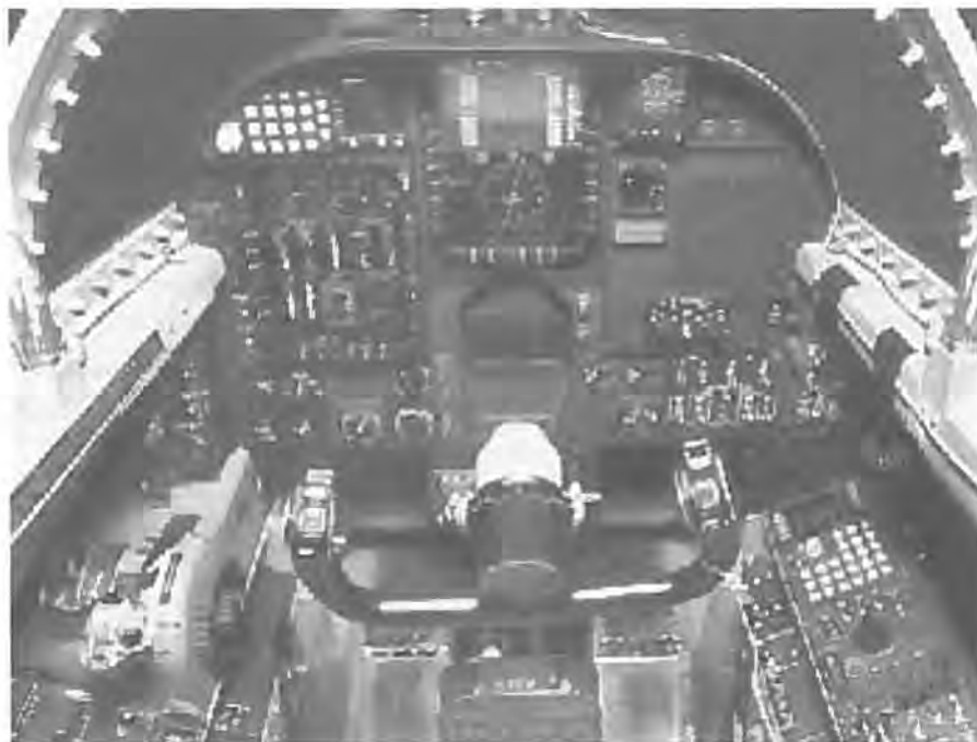
Det nye cockpit i U-2S rekognosceringsflyet, hvor piloten ikke længere skal vride sig halvt rundt i sædet for at skifte frekvens på radioen. (Billede Lockheed Martin).
