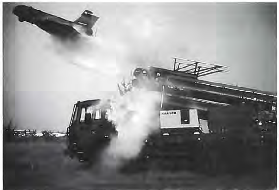
Det 4,2 meter lange og 330 kg tunge ubemandede observationsfly (UAV) under start fra rampen bag på lastvognen. På dette tidspunkt er UAV'ens hastighed 150 km/t.
