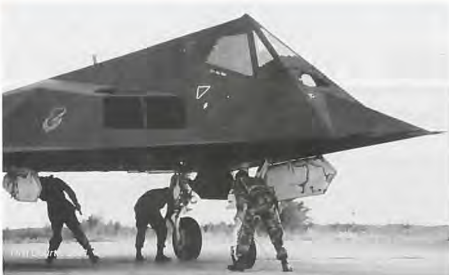
Teknikere i færd med at gennemføre eftersyn på F-117 før starten.
