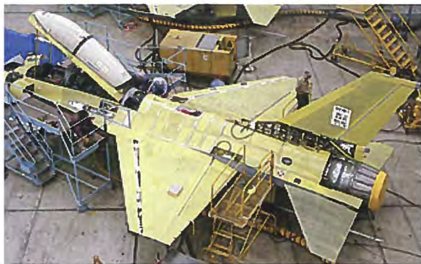
Udseende ind i produktionshallen hos Mitsubishi Heavy Industries i Kamaki-Soufabrikken, hvor F-2 fremstilles.
