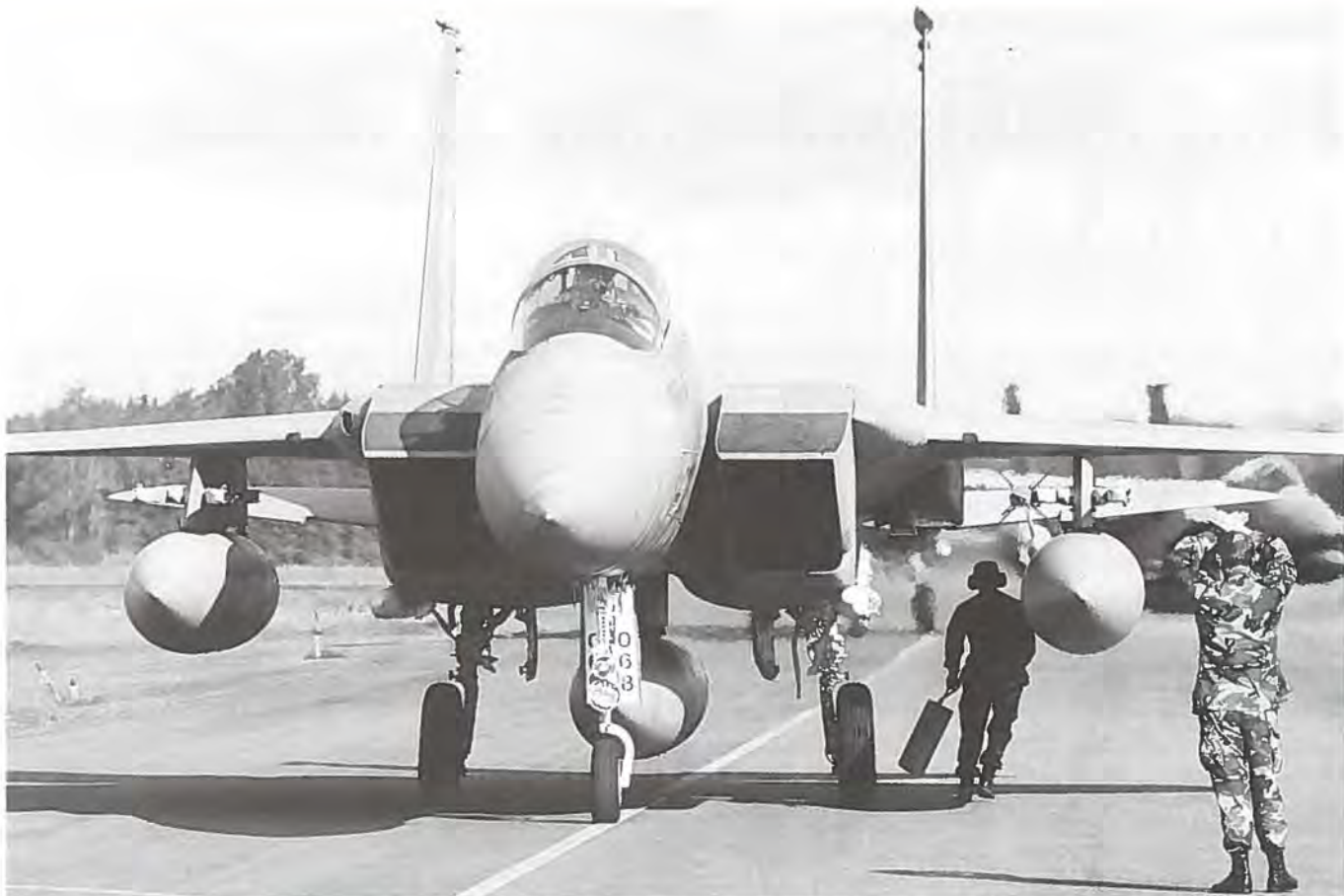
Så er sikringspindene fjernet, klodserne fjernes fra hovedhjulene, og man kan rulle ud til start. Under indsugningen sidder et AMRAAM, mellemdistance luft-til-luft missil, og oppe under vingen et AIM-9L Sidewinder kortrækkende luft-til-luft missil. (Billede, Fototjenesten, Flyvestation Aalborg).
