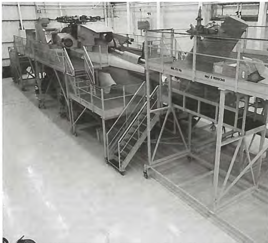
Teknikerne får deres sag for, når de skal til at fejlfinde på denne EH101, som instruktørerne kan behæfte med enhver tænkelig fejl. (Billede s-n).
