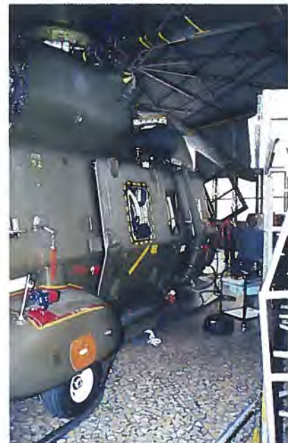
NH90 her i den version der kaldes Tactical Transport Helicopter (TTH) Bemærk hoistens placering (hejseværket) over kabinedøren.
