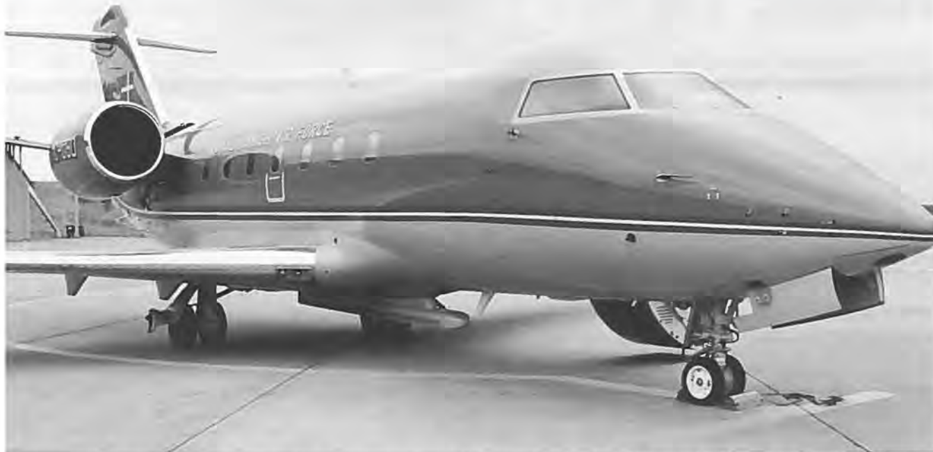
Challenger 604 flyet, der skal gennemføre overvågningen af havoverfladen fra luften. Under flyets bug ses den omtalte Side Looking Radar (SLAR) (Radar, der kan se mellem 20 og 35 km ud til siderne). (Billede J.E. Rasmussen, Fototjenesten, Flyvestation Værløse).
