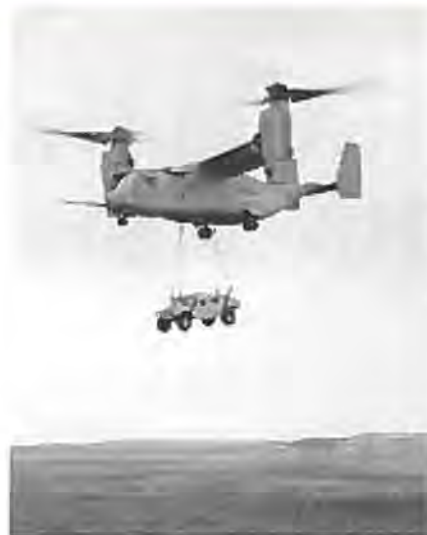
En Boeing V-22 Osprey på Patuxent River Naval Air Station i færd med at transportere en 2.948 kg tung HM-WWV i sling. (Billede Boeing).
