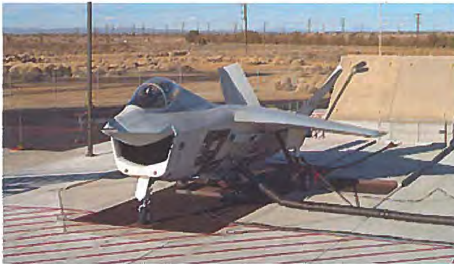
Boeing X32 B under hover test i den såkaldte Hover Pit, en rist hvor igennem det udviklede tryk ledes væk. Læg mærke til, at udstødningen er drejet nedad og lemmene lige bag cockpittet, hvor løfteviften sidder, står åbne. (Billede Boeing).
