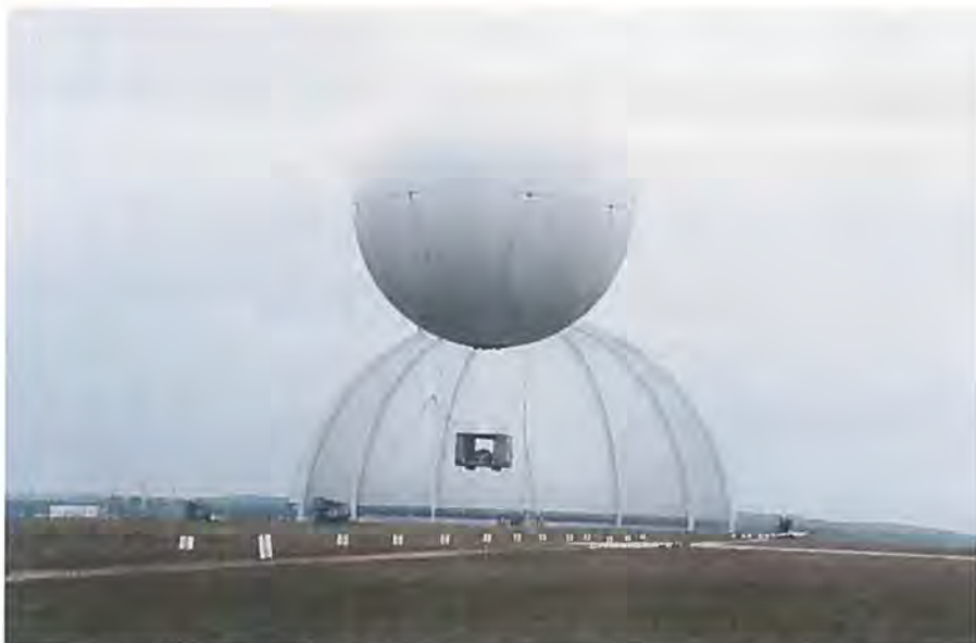
Minerydderen på de godt 40 tons transporteres i adstadigt tempo gennem luften af de fire store lastbiler på jorden. I baggrunden kæmpehangaren, hvor CL 160 CargoLifter senere skal bygges. (Billede s-n).
