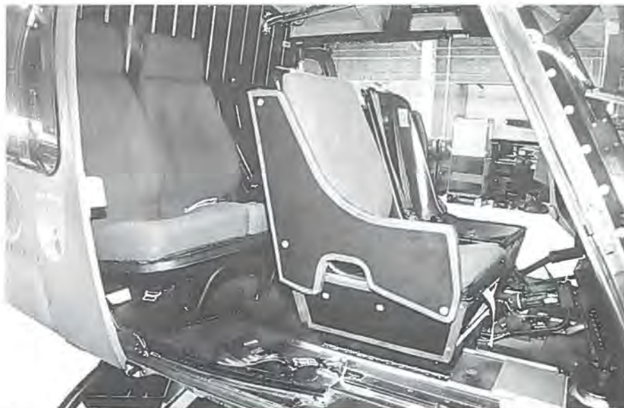
Pladen, som ligner et armlæn, der beskytter besætningsmedlemmet mod beskydning fra jorden. Lignende plader er monteret i bunden og på ryggen af sædet.
