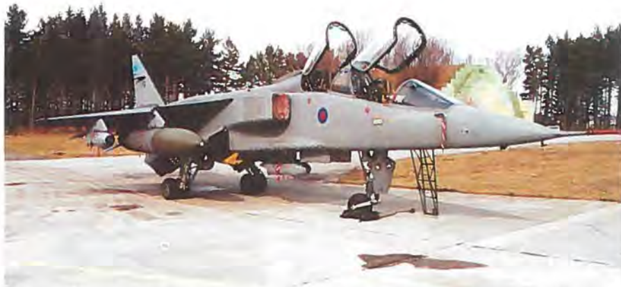
Jaguar T2, „T-Bird“. Det ekstra sæde til eleven har taget den plads, der skulle være til radaren og den ene af de to 30 mm Aden maskinkanoner.
