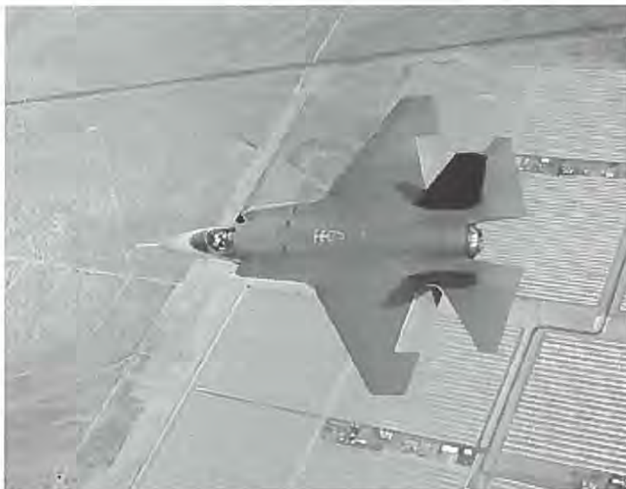
X35A, standardudgaven som skal leveres til US Air Force flyet kan kun starte og lande på konventionel vis på en almindelig startbane. (Billede Lockheed Martin).
