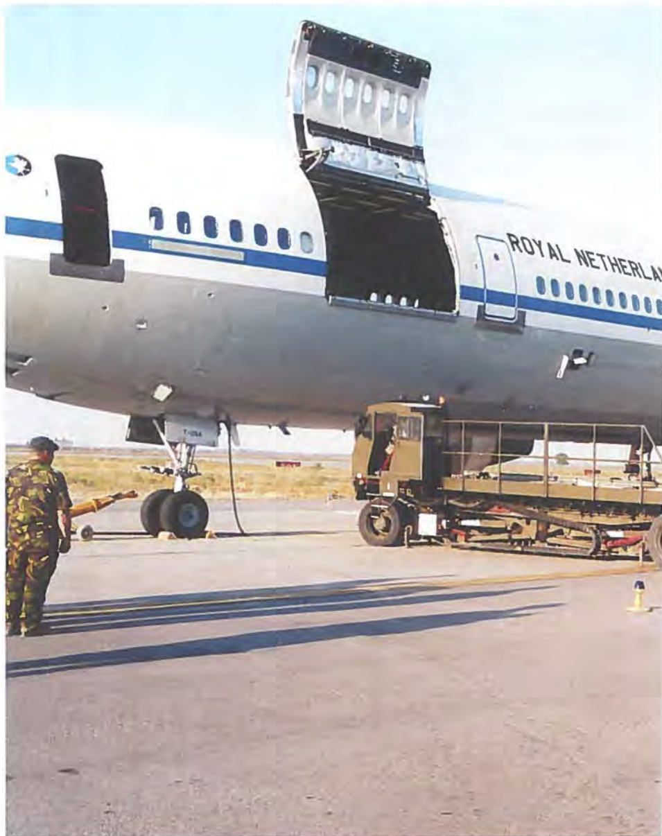
Sådan så det ud, når lasten skulle helt op til lastelugen på den hollandske KDC-10, godset op til lugekarmen. Bag den en 10.000 pounds gaffeltruck som er ved at anbrin-
