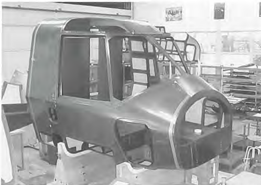
Cockpittet, der er fremstillet hos Eurocopter, Marignane i Frankrig. Fabrikken skal også fremstille, rotor, halegearkasse, elektriske systemer og flight control systemet. Her fotograferet hos Eurocopter Deutschland fabrikken i Donauwört ved München.
