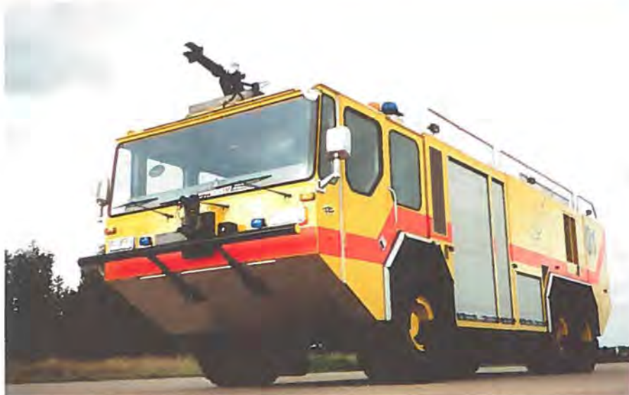
Flyvevåbnets nye „ørn” „Eagle 6” set sådan lidt fra neden. Det 30 tons tunge køretøj er ganske imponerende at se på, også fra ståhøjde. De skrå afskæringer for og bag hører sammen med, at køretøjet kan forcere en stigning på 50%. (Billede Torben Christiansen).
