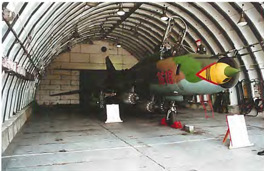
En af 8 Eskadra Lotnictwa Taktycznego SU-22M4 Fitter jagerbombefly udstillet for et meget interesseret publikum i en lidt dunkel shelter. Under flyet er der ophængt fire pods med ustyrede raketter og to luft-til-luft missiler til selvforsvar.
