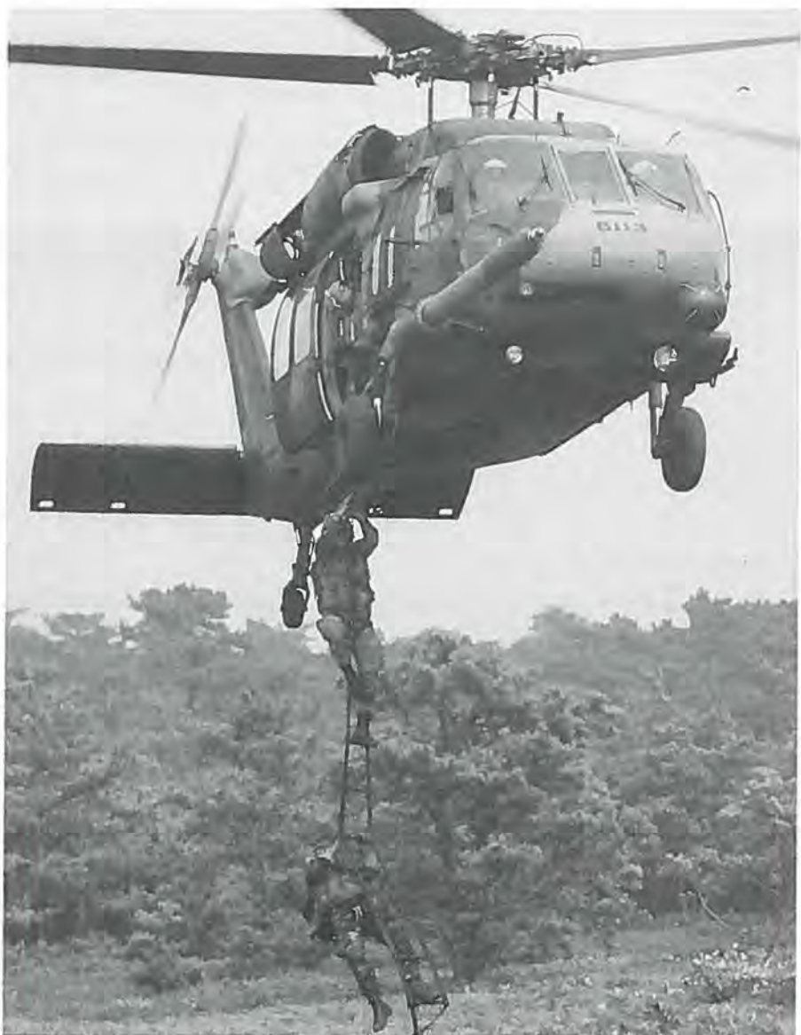
UH-60L Pawe Hawk her i Combat Search and Rescue og Special Operations versionen. Den kan refueles i luften og har 7,52 mm og 50" maskingeværer om bord til selvforsvar. Til brug under Special Operations har den et „Fast Rope System“, det vil sige kampsoldater kan landsættes medens helikopteren hover (svæver) over landsætningsområdet. (Billede Sikorsky).
