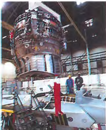
Billede af den løftevifte, der gjorde Lockheed Martins udgave af JSF X35 til vinder i konkurrencen med Boeing. Selv under testflyvninger på Edwards Air Force Base som ligger temmelig højt, og hvor det er varmt, kunne X35 levere mere løftekraft, end der var foreskrevet i specifikationerne. (Billede Lockheed Martin).
