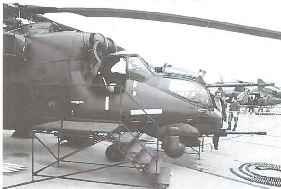
Rostvertol Mi-35M set fra den modsatte side, hvor piloten stiger ind fra styrbords side, medens skytten kravler ind fra bagbord.
