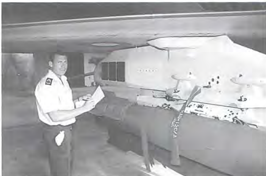
Vor hjemmelsmand i den Centraliserede Ammunitionstjeneste på Flyvestation Skrydstrup, oversergent Bo Dietz-Larsen. Han er i færd med det sidste papirarbejde på opladning af et F-16 jagerfly med MK82 High Drag bomber. High Drag betyder, at bombens haler folder sig ud, når den er kastet og bremser bombens hastighed.
