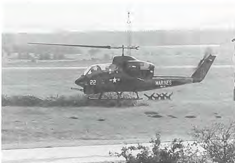
Bells Hueycobra, her vist i US Marine Corps versionen, AH-1J. Denne version havde en treløbet 20 mm XM-197 maskinkanon monteret under næsen. På stubvingerne kunne den bære enten pods (beholdere) til raketter eller miniguns (maskingeværer). Billedet er taget på Flyvestation Vandel i august 1976. (Billedet s-n).
