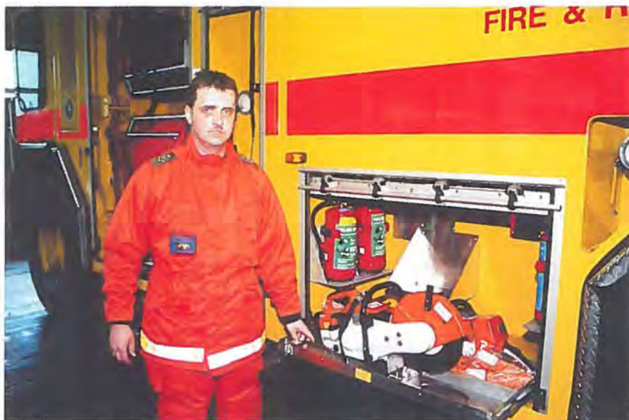
Er det ikke nok at bruge kloen, kan man bruge en motorskærer (vinkelsliber), som sidder på køretøjets modsatte side. Den enorme vinkelsliber bider sig igennem hvilket som helst på et luftfartøj.
