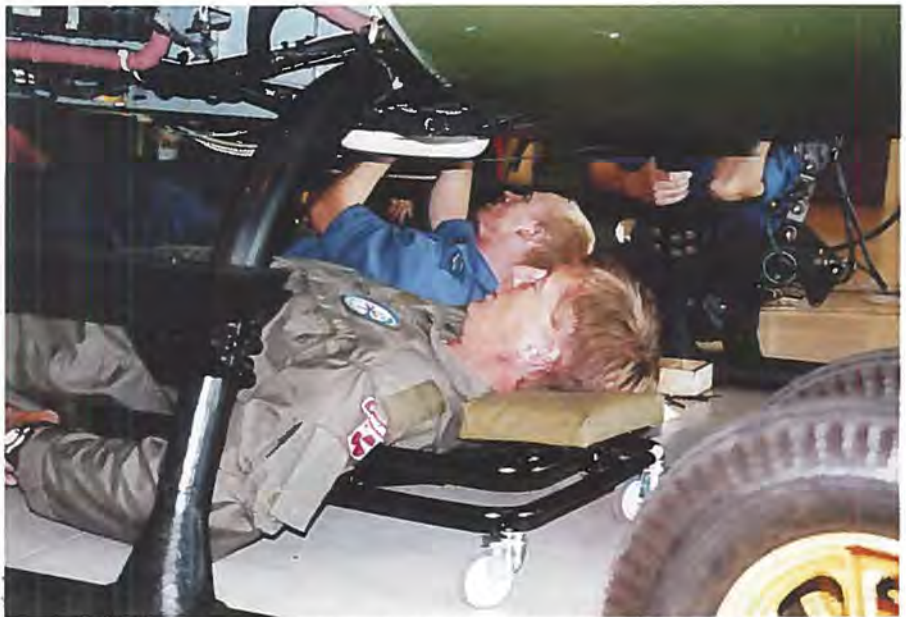
Der bliver monteret beskyttelsesplader i bunden af helikopteren. Det er flyveroverkonstabel Michael G. Hansen, Flyværkstedet, der er i gang med at montere pladen, medens testingeniør Hans Rasmussen, nærmest kameraet, følger processen.
