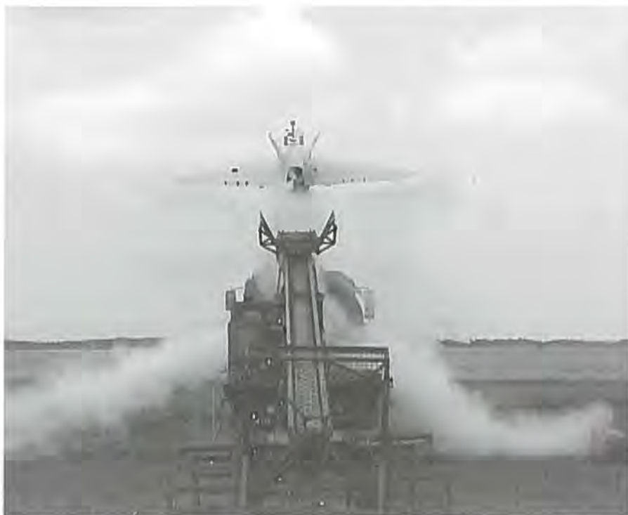
Når tårnfalken forlader sin mobile rampe, er hele dens flyvning planlagt og indkodet. Den kan flyve hele missionen selv uden indblanding fra kontrolcentret, også i eventuelle nødsituationer og under landingen. Operatøren kan dog til hver en tid skride ind og give flyet nye ordrer. (Billede via FMK).
