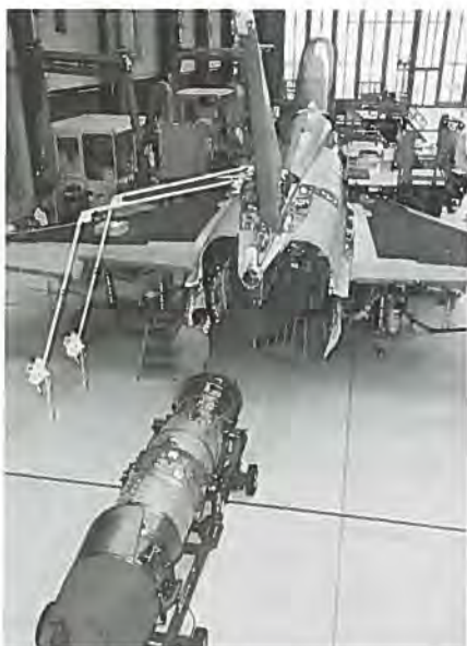
EJ200 motor klar til at monteres i Eurofighter Typhoon.
