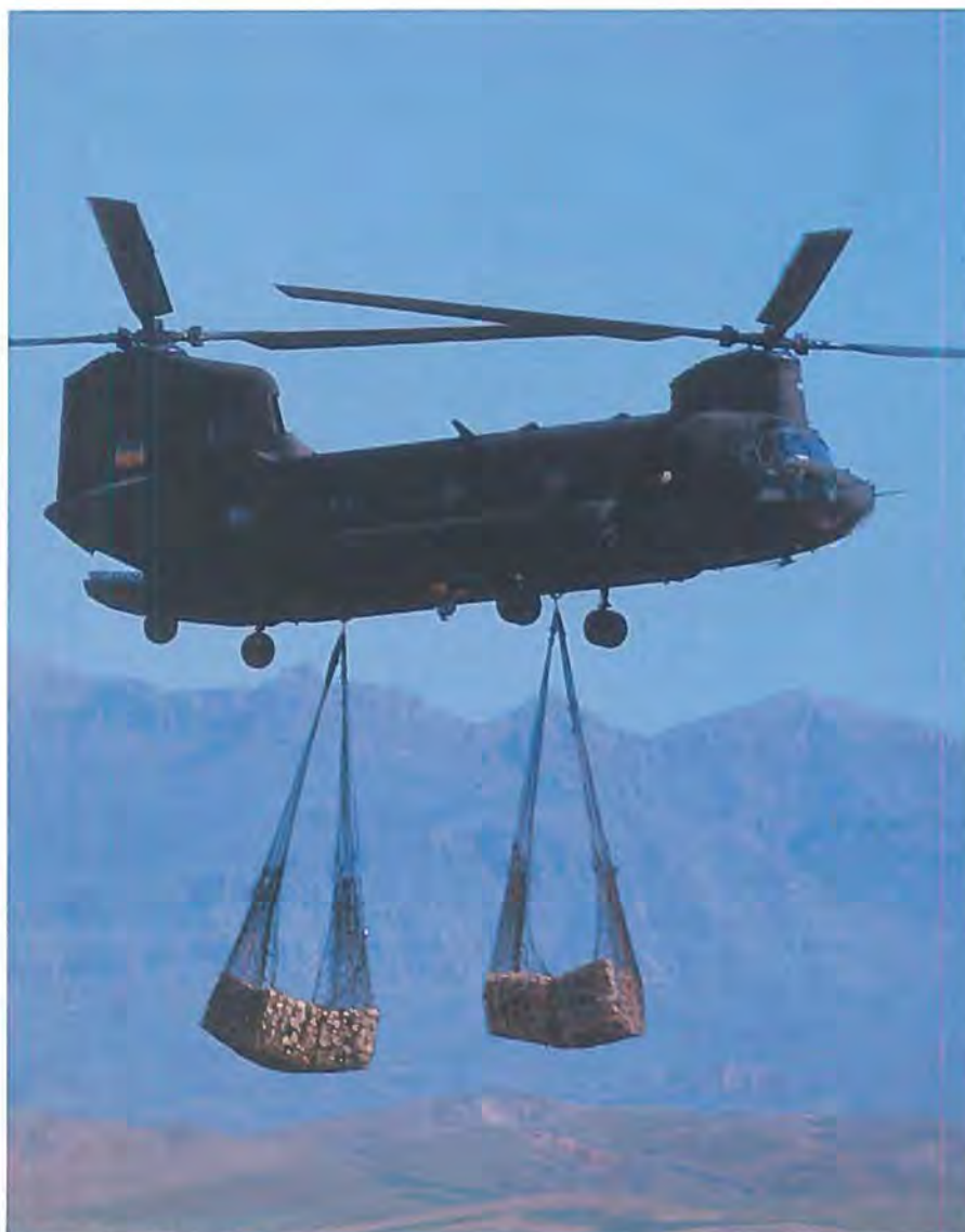
Boeings CH-47 Chinook har været én af arbejdshestene med at flyve specialtropper ind i Afghanistan. Den hængende last (sling) under helikopteren kan veje indtil 11,8 t. I lastrummet er der plads til 55 mand. (Billede Boeing).
