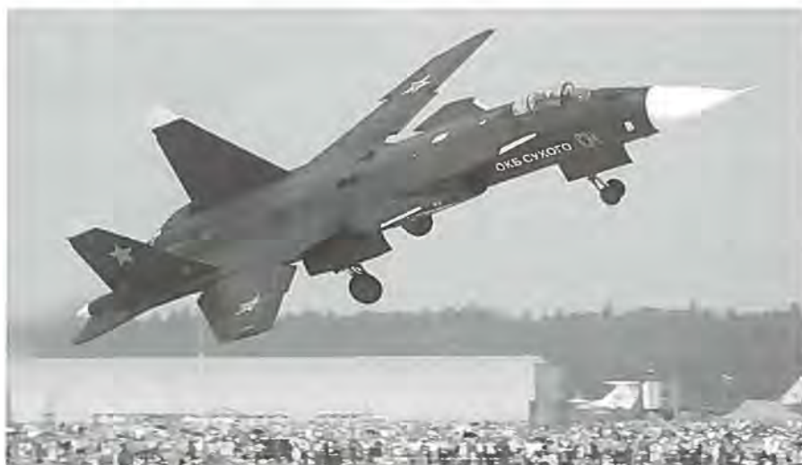
Sukhoi Su-47 med sit frække „X Wing”- design (fremadrettede vinger), hvor vingspidserne griber luften først. De små canards (forvinger) giver flyet ekstra manøvre evne.
