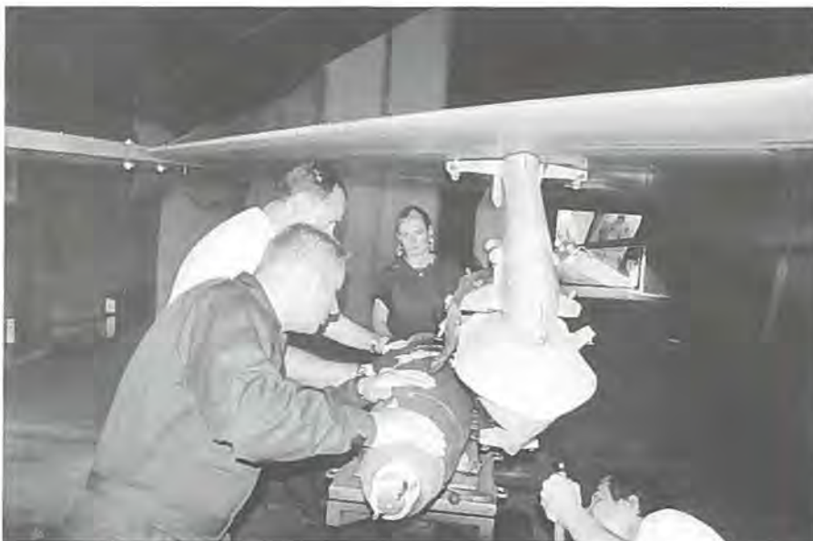
Fra v. er det holdlederen, oversergent Per Steckner, flyverspecialist J.S. Nielsen, flyveroverkonstabel C.S.K. Wilms og nederst i billedet flyverkonstabel J.T. Kjærsgaard, der er i færd med at hænge en MK82 jernbombe op på F-16's RTE-9 Rack Tripple Ejection – 9 (bombekasterophæng til tre bomber). En operation, der foregår med megen følelse og omhu.
