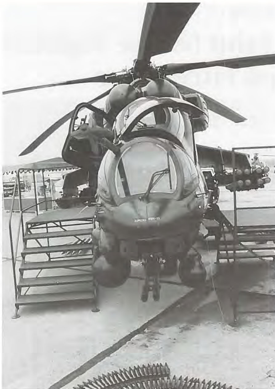
Rostvertol Mi-35M set lige forfra, hvor man ser direkte ind i de dobbeltløbede GSh-23 23 mm maskinkanoner. Ved siden af den sidder en ny UOMZ gyrostabiliseret GOES 342 dome, som indeholder henholdsvis FLIR og laserafstandsmåleren.
