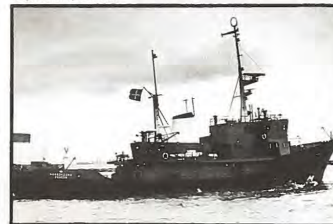
»Nordjylland« OUHT, Skagen, Fiskeriministeriet, redningsskib, Frederikshavn Værft 1967, Det Norske Veritas, 91 nrt, 475 brt, 261 tdw, 53,2 m.oa., 10,0 m, 3,37 m, 2 stk. Holeby Diesel B&W 823 MTBF 30, 1.960 hk, 8 to gasolie, 14 knob.
