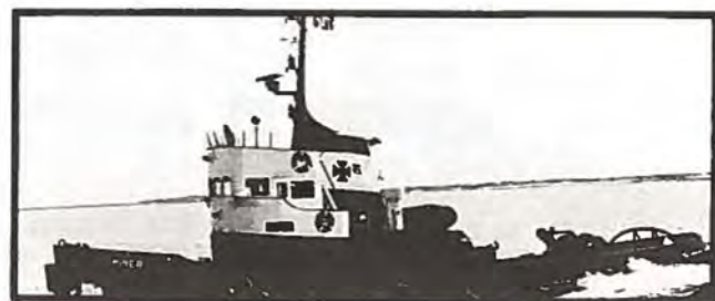
»Mimer«, Esbjerg (pæletræk: 25 tons)
