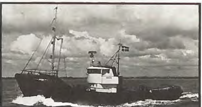
»Asbjørn«, Esbjerg (pæletræk: 20 tons)
