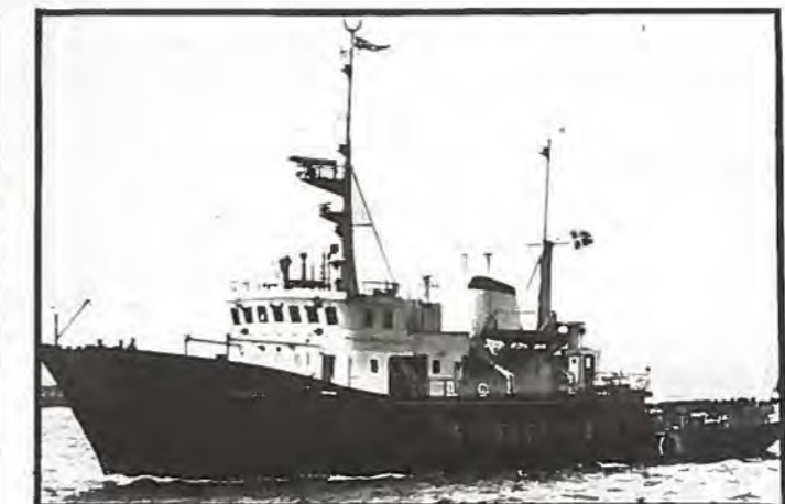
»Nordsøen« OXGD, Esbjerg, Fiskeriministeriet, redningsskib, Frederikshavn Værft 1968, Det Norske Veritas, 91 nrt, 475 brt, 261 tdw, 53,2 m.oa., 10,0 m, 3,37 m, 2 stk. Holeby Diesel B&W 823 MTBF 30f, 1.960 hk, 8 to gasolie, 14 knob.
