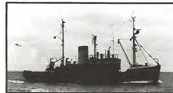
»Vestkysten« OUL, Thyborøn, Fiskeriministeriet, redningsskib, Nakskov Skibsværft 1944, 81 nrt, 321 brt, 39,28 m, 8,04 m, B&W-Alpha (1972) 9-cyl. 900 hk, 12 knob.
