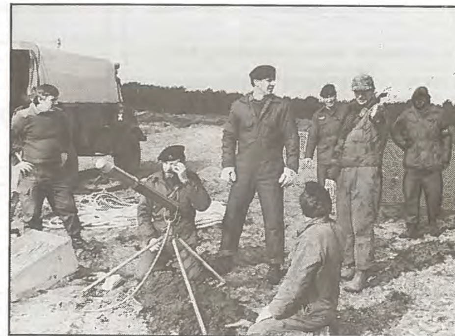
Så kraftig er rakettem, der skal drive linen fra kysten og ud til et evt. strandede skib. Men den skal også være i stand til at flyve med en line på slæb over vandet i den stærke storm.
