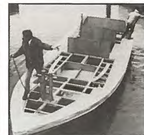
Det faste (stive) skrog er opdelt i vandtætte rum af 5 langskibs kassestativer og 7 tværskibs vandtætte skodt.
