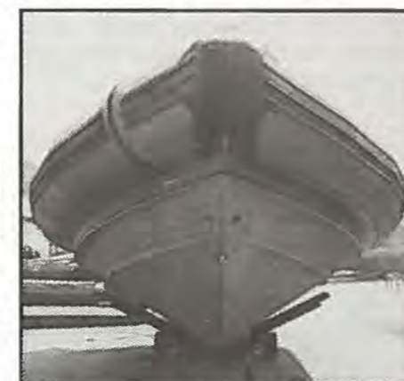
Skroget har et skarpt, dybt V for blød gang i søen og gode søegenskaber.
