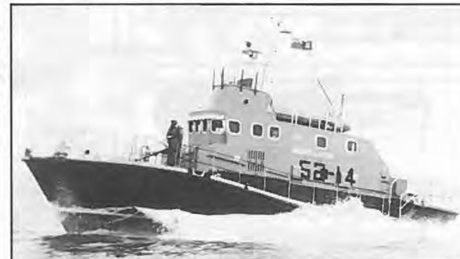
Arun-klassen blev noget nær fuldført i udviklingen af større engelske redningsbåde. 30 stk. er bygget af denne type og udstationeret ved forskellige engelske redningsstationer, hvor der er fast havn.
