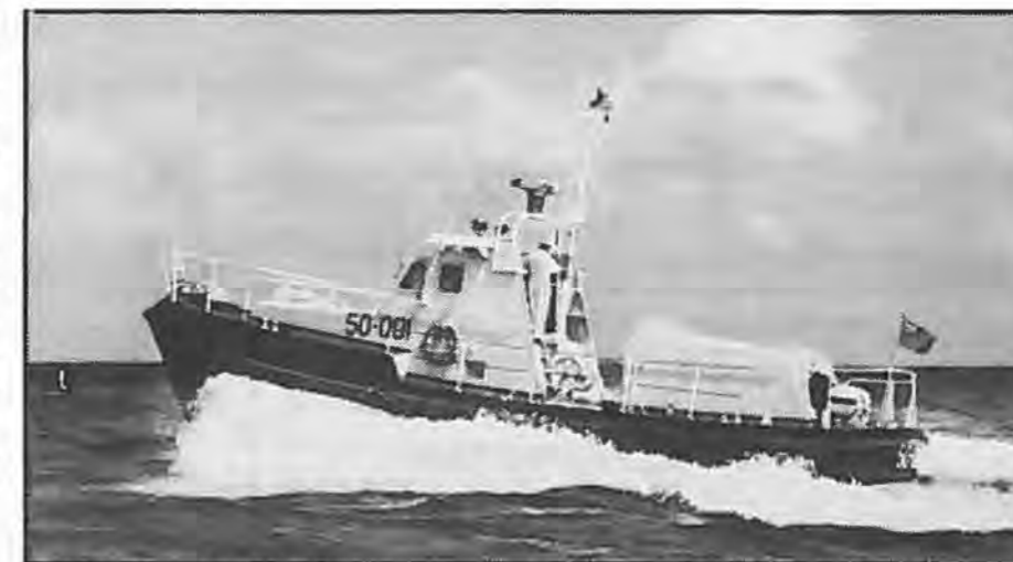
RNLI videreudviklede den amerikanske 44 fods redningsbåd. I England benævnt: Wavenye-klassen. Det blev til den 50 fods store Thames-klasse, som ses på dette billede. Nr. 50-001 er stationeret i Dover.
