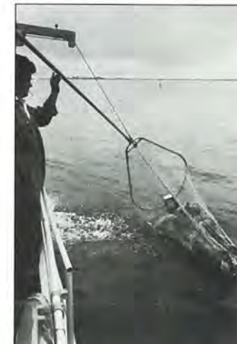
MRB 35 i Thyborøn er forsynet med dette udstyr til opsamling af forulykkede.
