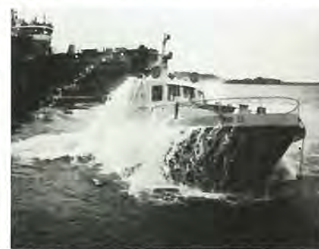
MRB 35 er selv-rejsende med intakt styrehus, sådan som disse billeder fra krængningsprøver viser. Det store spørgsmål var, om ruderne ville holde. Læg mærke til, at båden har fart på, hvor den kommer op igen. Vandet slynges ligefrem ud til siden.
