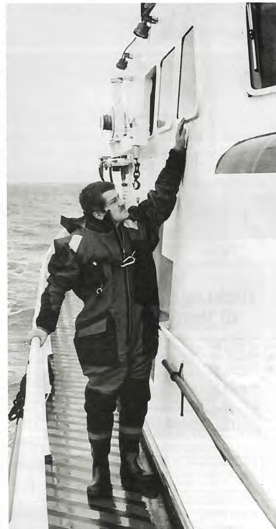
På billedet viser Uffe Rebsdorf fra Neksø hvor højt vinduerne i »L. Rosenfeldt«s styrehus sidder over dækket. Af sikkerhedsmæssige grunde kan ingen af de forreste vinduer åbnes, og føreren har ingen mulighed for at se, hvad der foregår på dækket. Han kan fra styrepladsen ikke engang se Uffe, selvom han står lige under vinduet. (Foto: Andreas Vrist)
