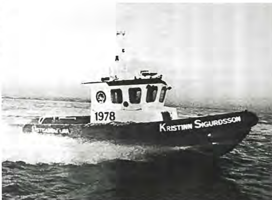
Den 12 meter lange nye lodsåbåd i Dundee er næsten en krydsning mellem en konventionel båd og en let redningsbåd.
