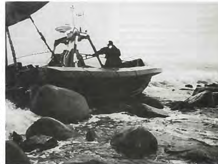
Station Sæbys lette aluminiumsbåd holdt forbausende godt til strandingen på stenrevet ved Hirsholmen. Båden fik kun små skader, selvom den stod på revet hele natten og om morgenen var hoppet 15-20 meter hen ad det.
