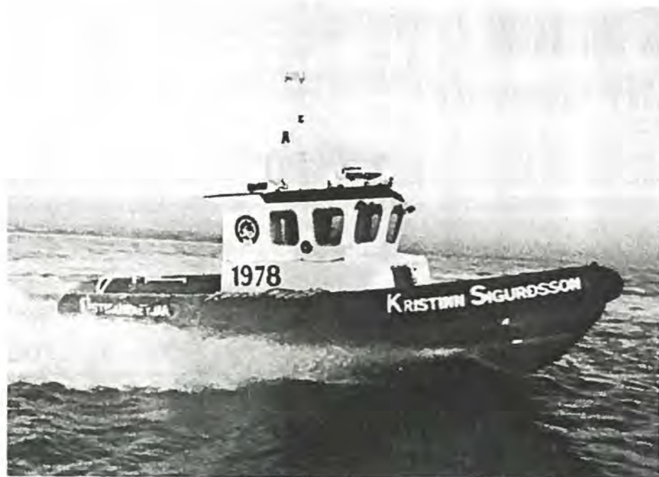
Den nye islandske redningsbåds skrog er en direkte videreudvikling af Uni-33-skroget.
