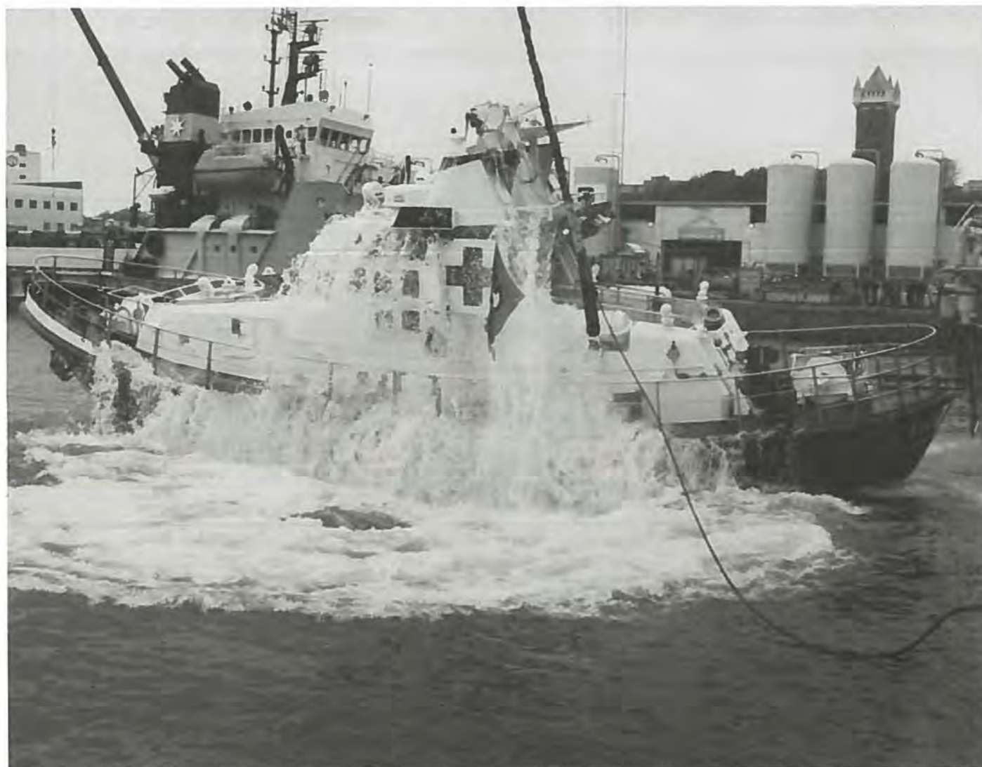
Det tog mindre end fire sekunder for de to nye redningsfartøjer at rette sig op, da de blev sluppet under krængningsprøven. Her ses »Emile Robin« kaste vand af sig, idet den kommer op. (Foto: John Randeris Hansen)
