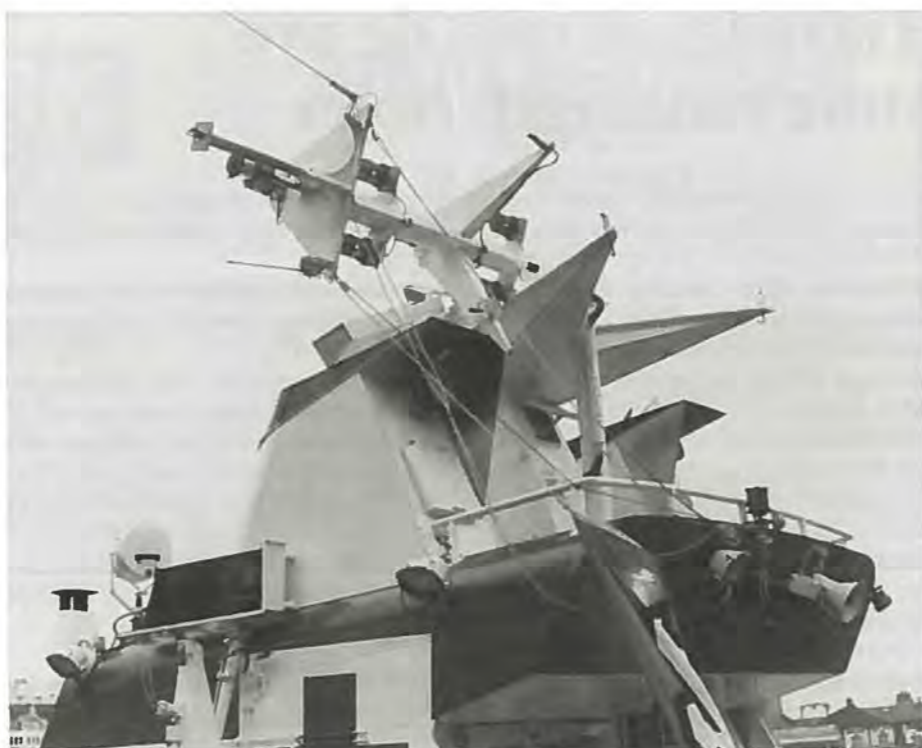
Masten er indrettet, så den lægger sig ned, hvis skibet triller rundt. På den måde bliver der mindre modstand i vandet, når skibet skal rejse sig igen. (Foto: John Randeris Hansen)
