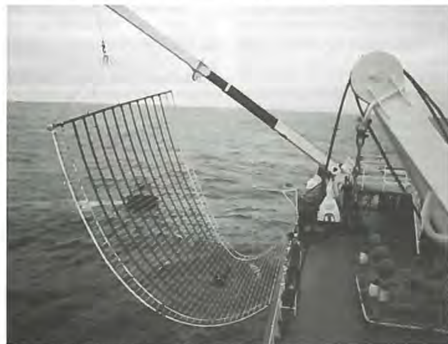
En forulykket reddes op af vandet med det norske redningsnet. Det er især velegnet til brug i større fartøjer med højt fribord.
