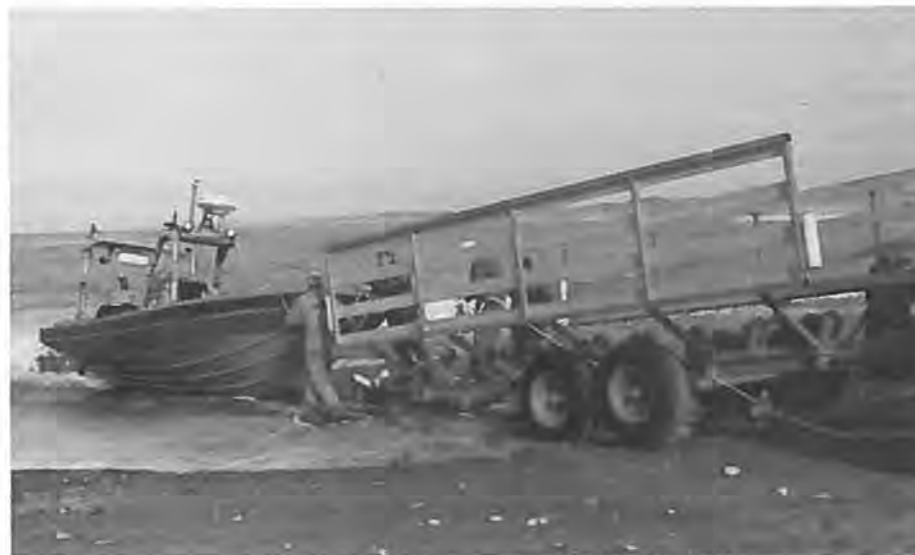
GTCeren trækkes op på den specialbyggede vogn, hvorfra den også kan sættes ud igen. Vognen trækkes af en traktor. (Foto: Villy Yde Kjærgaard)
