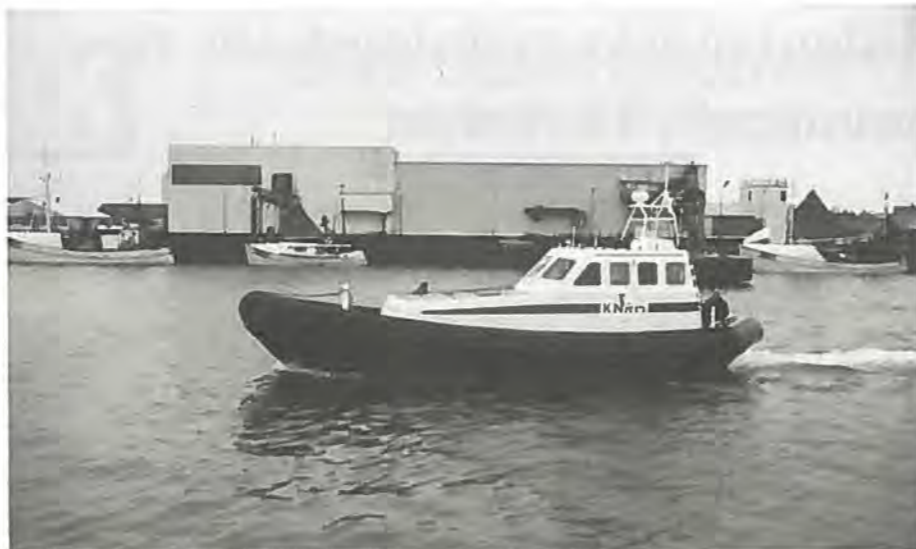
Den store hollandske Medina-type "Jan v. Engelenberg" er af samme størrelse som den danske HRL, der stadig kun findes på papiret. Med to dieselmotorer hver på 700 HK har den en topfart på 37 knob, og hollænderne bruger den i al slags vejr.
