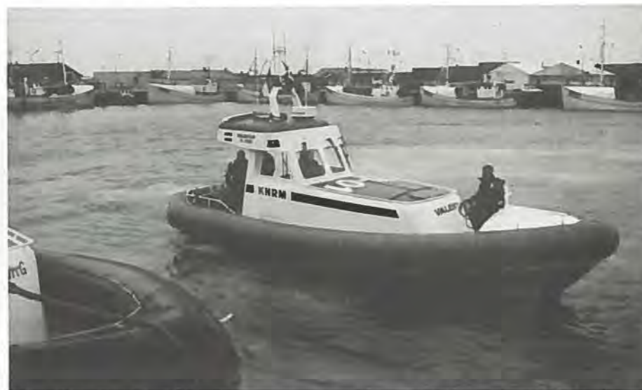
Den lille hollandske Medina-type er en anelse mindre end den nye danske LRB. Den er 10,6 meter lang og har to dieselmotorer, hver på 400 HK. Topfarten ligger på 37 knob.
