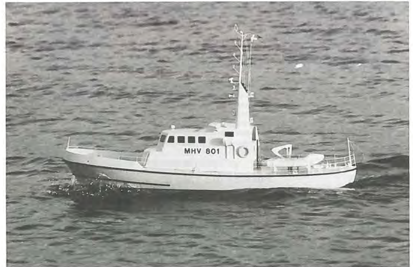
Model af det nye hjemmeværnsfartøj i tolvtedels størrelse. Modellen er afprøvet i prøvetank, og der var fuld tilfredshed med sejlegenskaberne.
