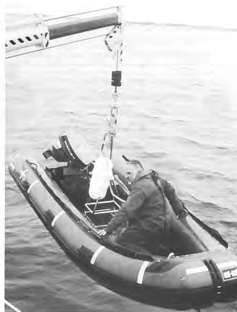
Den lille gummibåd med fast bund kan sættes ud med den hydrauliske kran på agterdækket.
