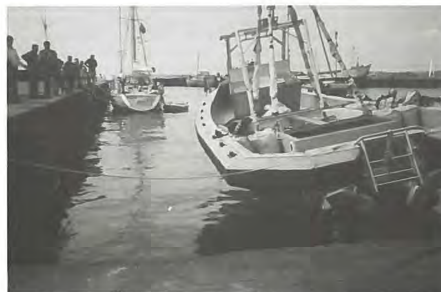
Stødprøve blev udført ved at slynge XRB 10 mod kajen.
