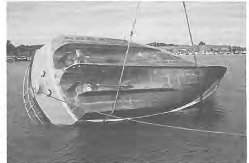
Som dette billede fra krængningsprøven viser, ligger begge skruer godt beskyttet i tunneler.
