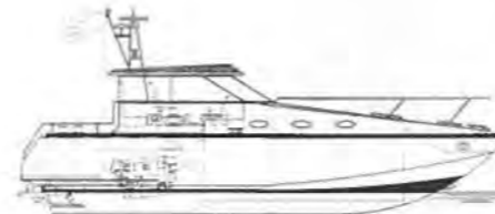
Spanteopbygningen i aluminium til GTC 1030 hvori også indgår de lufttætte rum, der giver det lette redningsfartøj opdrift til at klare selv store vandmængder indenbords.
