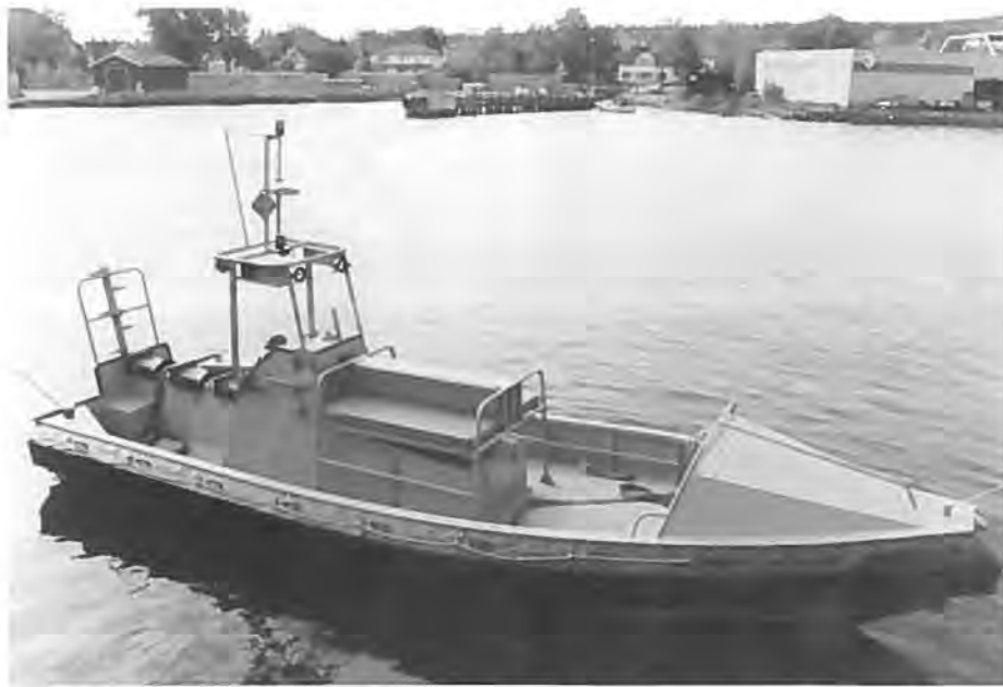
Aluminium hele vejen igennem ses tydeligt på denne åbne redningsbåd fra Tønsbergværftet. Som alle Henriksens Specialbåde (HS) er bundskrogets vinkel på 26 grader agterude og 38 ved boven i en trediedel af skibets længde. Typen HS 900 VD er 8,6 meter lang, 2,9 meter bred, og kan med 300 HK motor gøre en fart på 29 knob. Denne båd blev bygget til Østlandets Sjøforsvarskommando i 1992.
