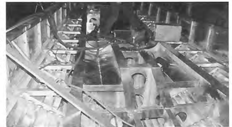
Spanteopbygningen i aluminium til GTC 1030 hvori også indgår de lufttætte rum, der giver det lette redningsfartøj opdrift til at klare selv store vandmængder indenbords.
