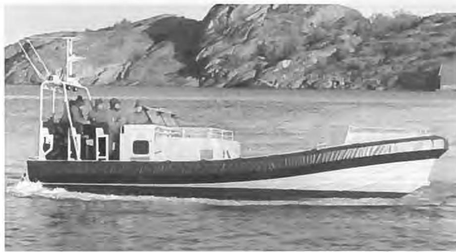
Prototypen HS 1000 2VD med 2x300 HK motorer - fart 36 knob. Sammenlign med forsidebilledet den videreudviklede HS 1030. Mandskabet er her bedre beskyttet mod søsprøjt ligesom styrehus-konsollet er flyttet lidt mere frem. Den seneste norske udgave har fået motorkraften øget til 680 HK, og det har givet HS 1030 en max fart på 38,3 knob.
