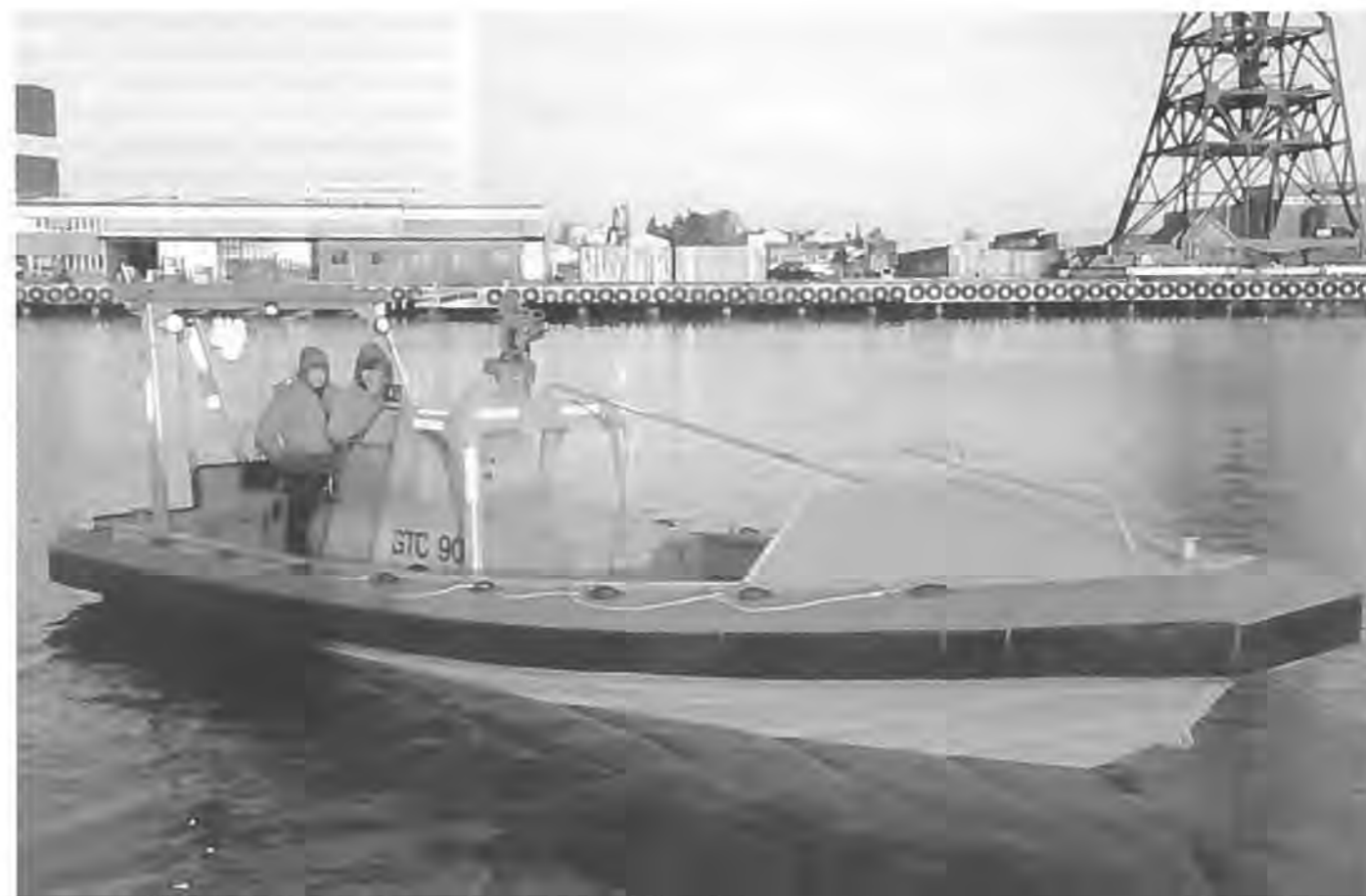
GTC 900 som der er leveret 10 af til Farvandsvæsenet findes med to motorstørrelser. En med 306 HK der giver båden en max fart på 30 knob og en med 340 HK motor, der øger farten til 34 knob. I baggrunden ses en del af værftet.
