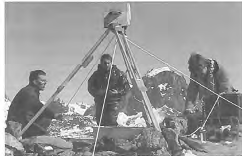
Til brug for søopmålingen i Grønland er det nødvendigt at kende positioner af synlige punkter på land set fra havet. det tager Oceanografisk afdeling sig af.
