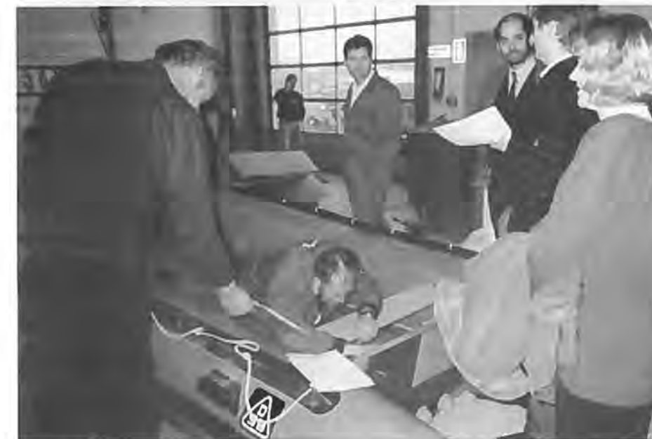
Viking Life Saving Equipments regionschef Bent Kromand præsenterede fabrikkens MOB-båd type D470GP for redningsfolkene fra hhv. Nørre Vorupør og Hvide Sande. Begge stationer sagde ja til typen og har nu fået bådene leveret. Bådene er 4,7 meter lange og 2 meter brede. De vejer uden motor og tanke ca. 175 kg. FOTO: FINN BJØRNAGER
