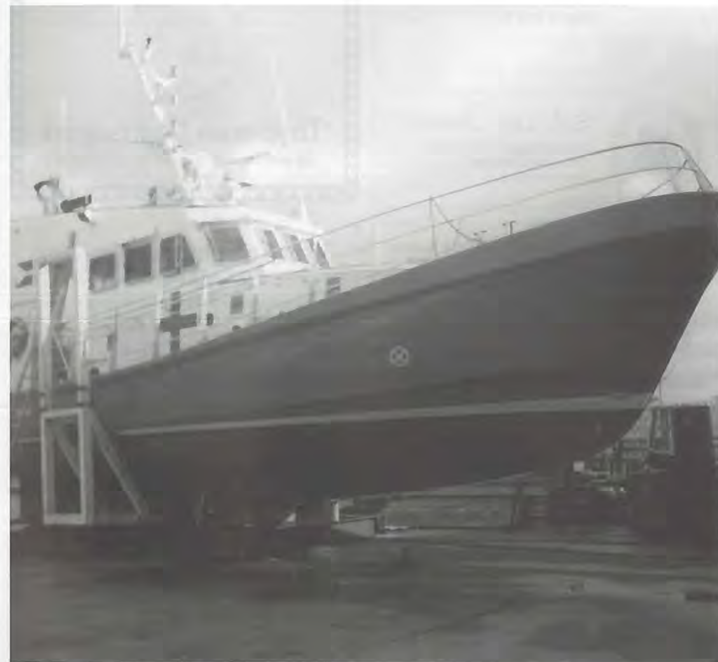
»Morten Stage« på land, ved Mathis Værft A/S i Ålborg, for at få monteret en kølskinne på 164 kg. Dette skulle gerne afhjælpe, at stabiliteten bliver så god, at den bliver godkendt.
