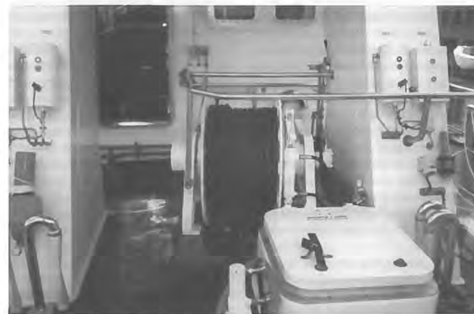
Bugserspillet står godt placeret inde i læ.
