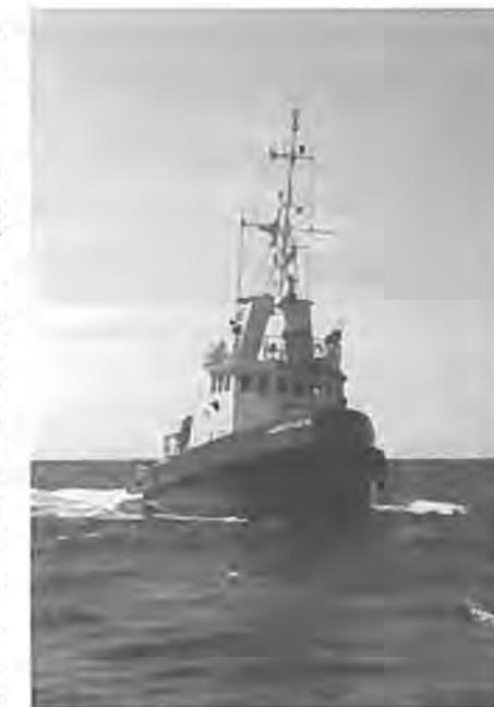
»C.B. Claudi« er et helt specialbygget redningsfartøj, der er særligt egnet til bugsering af havarede skibe.
