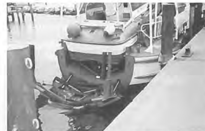
Nedlagt hæk. De to opstående stivere virker som et fæргеleje.
