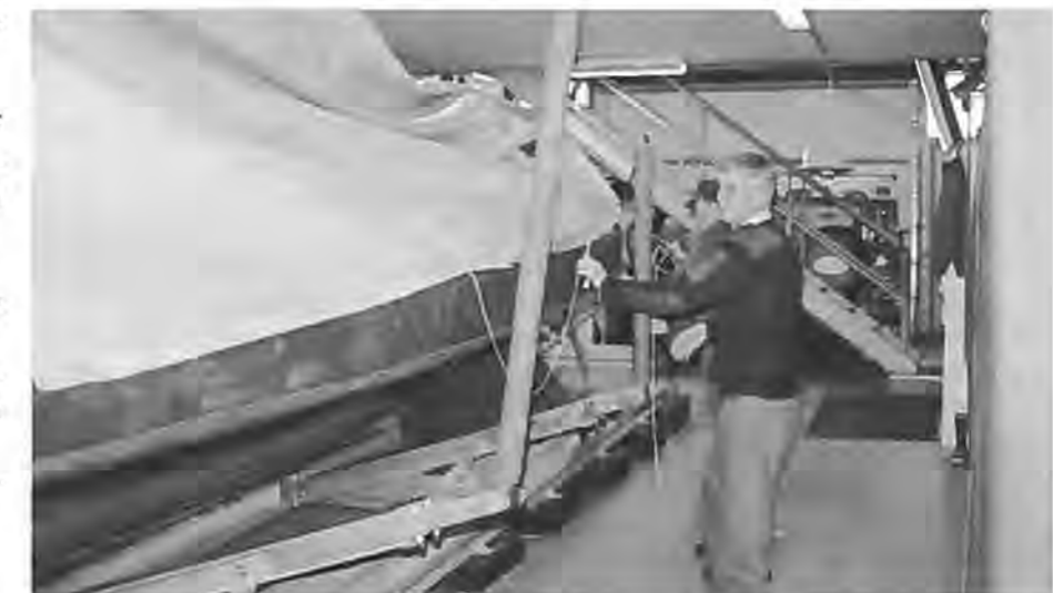
Skagens LRB lukkes tæt med presenning inden afprøvningen med lys.
