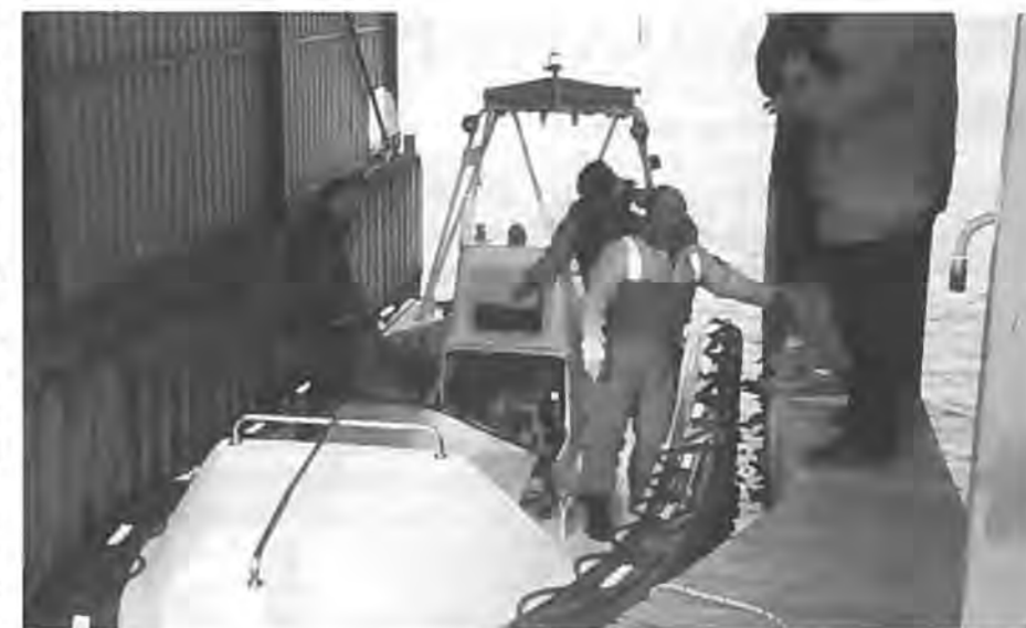
Åge Venø ombord i prøvebåden. Volvo Penta motor på 230 HK Kamewa 22 waterjet, fart ca.42 knob.
