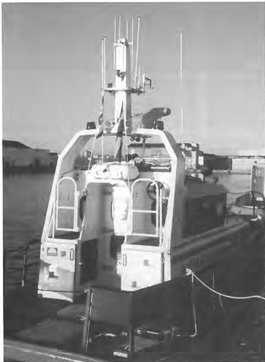
Læg mærke til de to ståpladser, hvorfra båden kan manøvreres.
