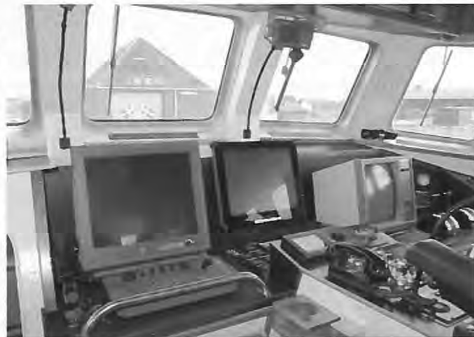
Skråpulten på L. W. Dam blev afløst af en vandret pult, så instrumenterne kunne anbringes mere hensigtsmæssigt, hvorved bl.a. spejlinger fra instrumentlyset om natten og hindringer af udkigget kunne undgås.
