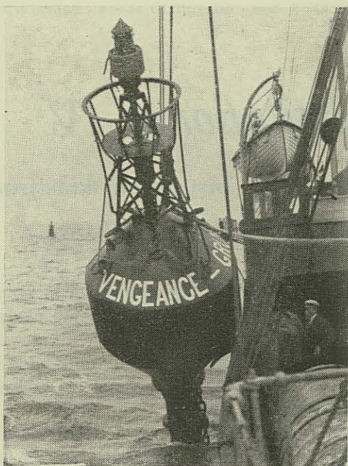
Skiftning af en Lystønde.
