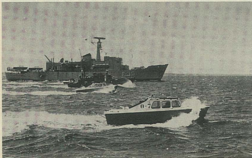
Et af Søværnets inspektionsskibe og tre af Søkortarkivets specialfartøjer opmåler en storskibsroute (Søkortarkivet).
