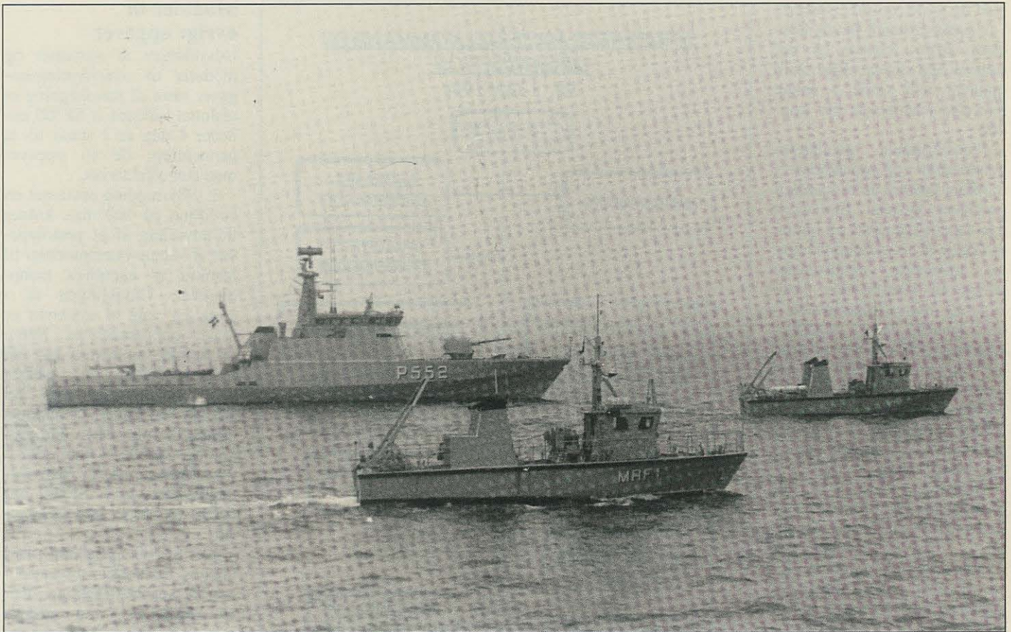
STANDARD FLEX 300 i minekæmpelsesrollen (MCM), hvor der anvendes to fjernstyrede minerydningsfartøjer (MRF). P 552 »Havkatten« var i dette tilfælde kommandoplatformen for MCM-operationen.
