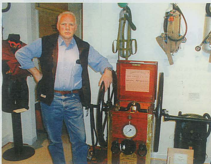
Chr. Koudal viser en dobbeltvirkende 1-cylindret dykkerpumpe, renoveret fra a til z, som er fremstillet i London i 1950'erne.
