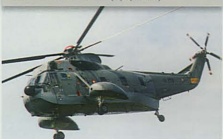
Redningshelikoptere. Max. startvægt 9,7 ts. Lgd. 16,7 m. Rotordiam. 18,9 m. Max. hastighed 144 knob. U. udfasning.
