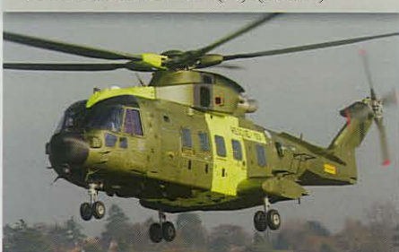
Redningshelikoptere. Max. startvægt 14,6 ts. Lgd. 19,5 m. Rotordiam. 18,6 m. Max. hastighed 167 knob.
