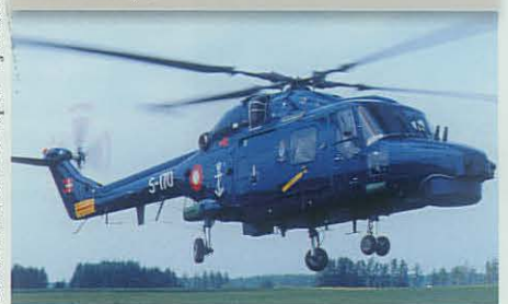
Marinehelikoptere. Max. startvægt 5,1 ts. Lgd. 11,9 m. Rotordiam. 12,8 m. Max. hastighed 145 knob.
