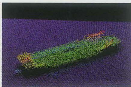
Vrag på 24 meter vand der rager 2,5 meter op over havbunden afbildet i dybde dataene.
