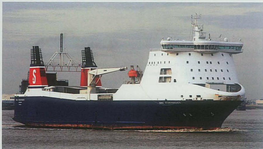
"ARK Forwarder" bygget i 1998 er chartret af ARK-projektet fra svenske Stena Line. Skibet er på 21.000 bt. Længde: 166 m. Bredde: 25,5 m. Dybgang: 7,4 m. Servicefart: 22 knob. På nuværende er det ARK-projektets mest moderne enhed af tilsvarende tonnage.
