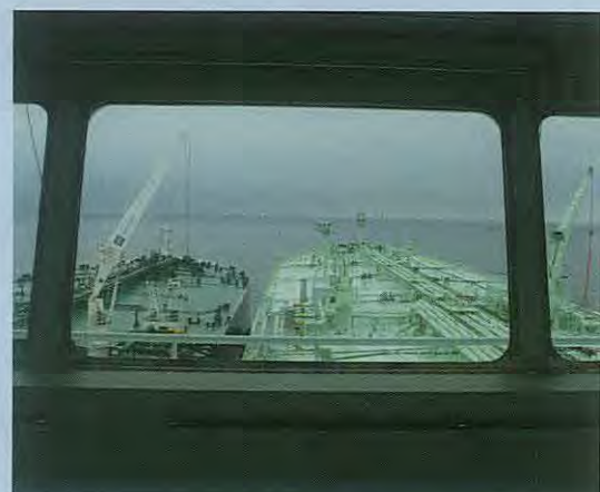
Lodsen kan også medvirke til en ship-to-ship operation, som er overførsel af last fra et skib til et andet. Manøveren udføres, mens skibene ligger langs hinanden, som her på billedet.
