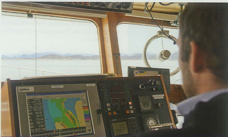
Tekniker Jesper Dahl står ved roret og følger skibets kurs i et elektronisk søkort på en skærm foran ham. Dybderne fra ekkolodet plottes øjeblikkeligt ind på kortet, en farve til hvert dybdeinterval.
