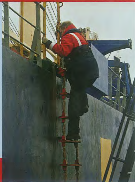
En lods fra DanPilot på vej op ad lodslejderen, som er den rebstige, lodsen benytter for at komme om bord på skibet.
