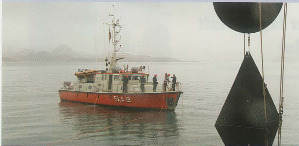
Opmålingsskibet SKA12 har sejlet søopmåling i grønlandske farvande siden 1989. Begge skibe hejser signalet kugle-diamant-kugle, inden en opmåling begynder. Det betyder begrænset manøvreedygtighed.
