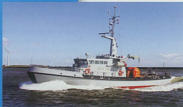
MHV 900-klassen (12 enheder) 113 tons displacement. 27,2-5,5-2,5 m. 13 knob.
