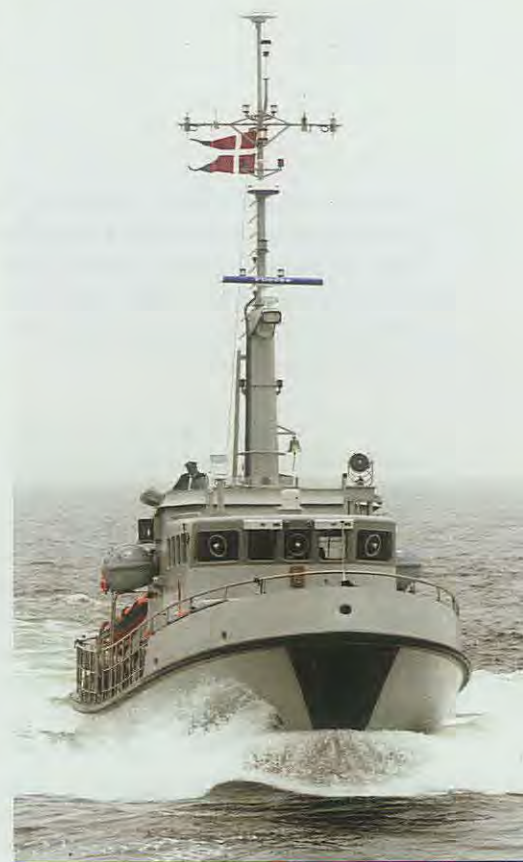
Marinehjemmeværnet råder over tolv 900-klasserfartøjer, sytten 800-klasserfartøjer og et 850-klasserfartøj. De er mellem 23,7 og 27,2 meter lange og sejler med en max hastighed på 13 knob. (Foto: Ole Friis.)
