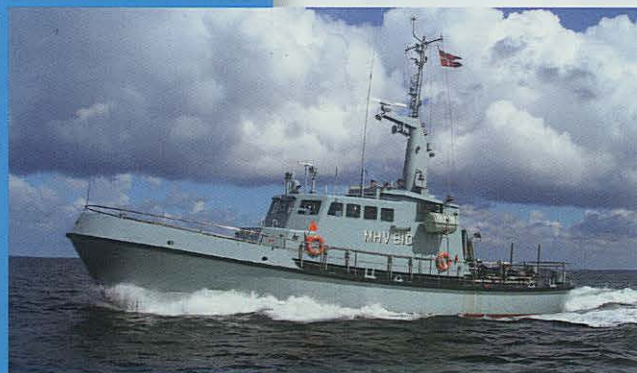
MHV 800-klassen (17 enheder) 85 tons displacement. 24-5,6-2 m. 13 knob.
