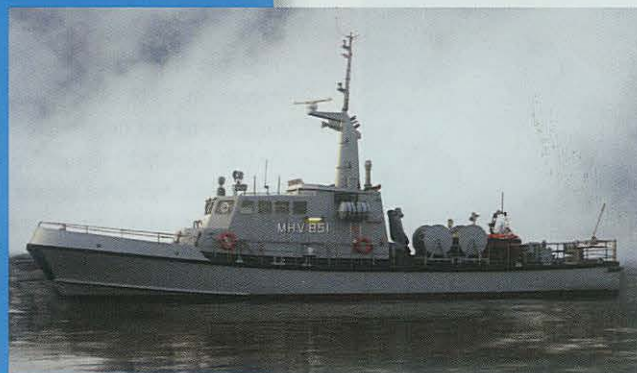
MHV 851-klassen (1 enhed) 113 tons displacement. 27,2-5,5-2,5 m. 13 knob.
