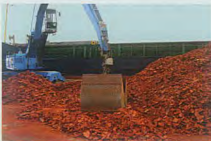
Skrukkede knuste teglsten fra Højslev Teglværk på vej til Holland, hvor de genopstår som tennisbanegranat.
