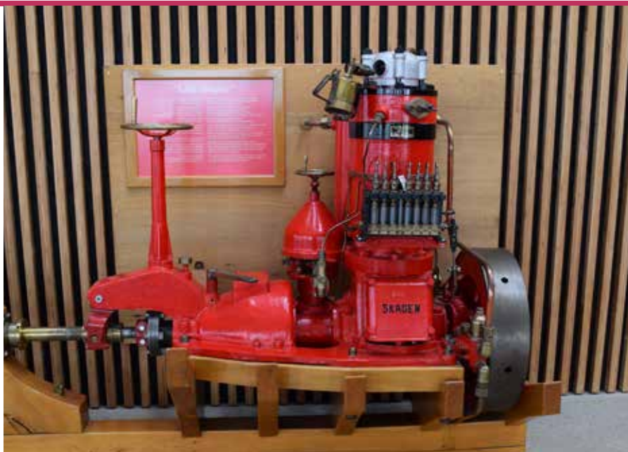
▲ Totaktmotoren "Lille Skagen" var op gennem 1920'erne synonym med fiskeriet fra den nordjyske fiskerby. Denne model er en 15/18 hk-motor med 1 cylinder. Motorerne blev fortrinsvis brugt af fartøjer, der drev fiskeri med rusetejner, garn, kroge, snurrevod og bundgarn. En lidt speciel anvendelse af "Lille Skagen" var i Østgrønland, hvor et eksemplar drev nødgeneratoren på Siriuspatruljens base.
