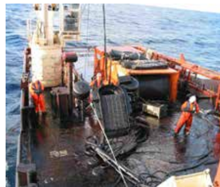
▲ Tyndtflydende oliefilm opsamlar med forskellige typer skimmere alt efter oliens tykkelse. GUNNAR THORSON er desuden udstyret med en grab til opsamlar af tyktflydende og størket olie på overfladen. Det er ofte et meget beskidt arbejde, som det ses her om bord i GUNNAR SEIDENFADEN under oprydningen efter forliset af tankskibet "Prestige" i 2002.
