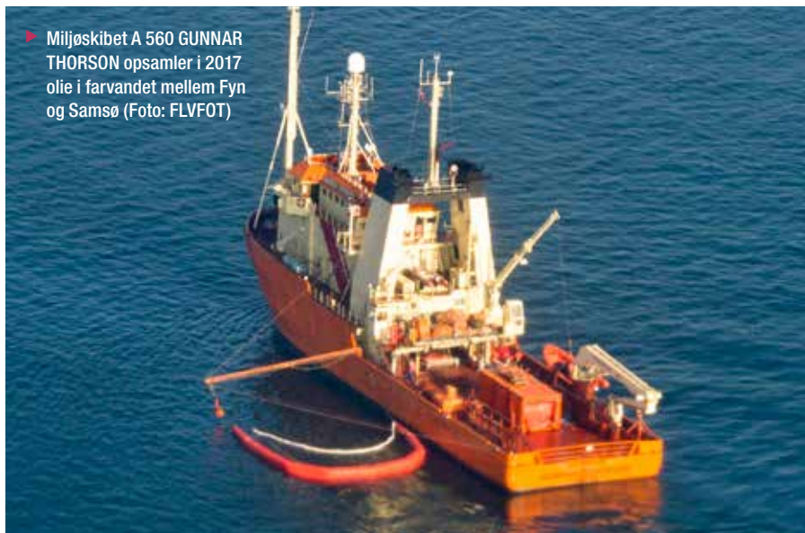
▲ Tyndtflydende oliefilm opsamlar med forskellige typer skimmere alt efter oliens tykkelse. GUNNAR THORSON er desuden udstyret med en grab til opsamlar af tyktflydende og størket olie på overfladen. Det er ofte et meget beskidt arbejde, som det ses her om bord i GUNNAR SEIDENFADEN under oprydningen efter forliset af tankskibet "Prestige" i 2002.
