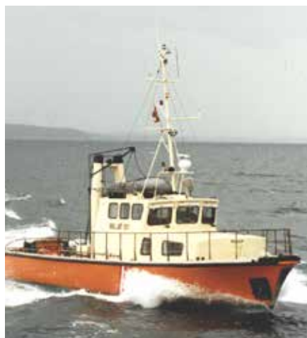
▲ Underlagt SEATRUCK-klassen er også Søværnets tre lægtvandsfartøjer, der er navngivet MILJØ 101, 102 og 103. De kræver normalt en tremandsbesætning og bruges til at opsamle olie på lavt vand. Her MILJØ 101, der har tjent miljøberedskabet siden 1977.
