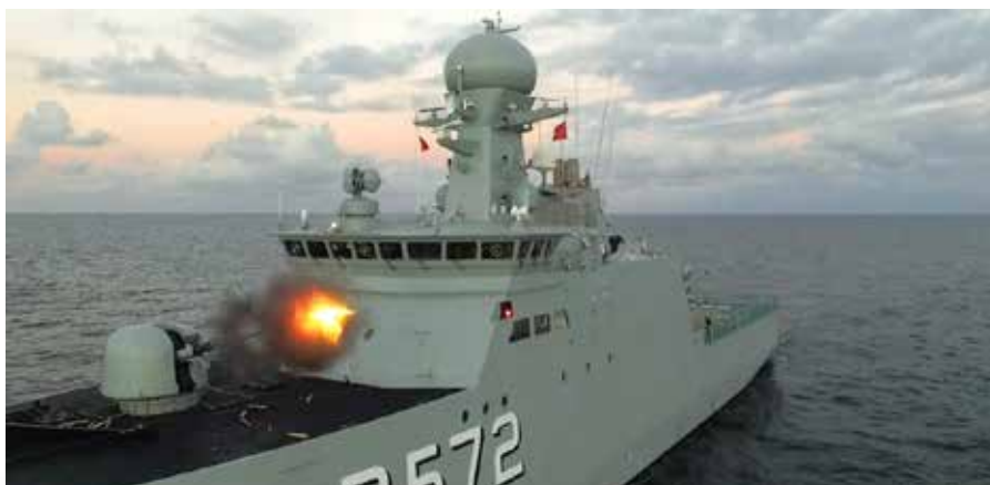
▲ KNUD RASMUSSEN-klassen er bevæbnet med en af Søværnets standard 76-mm-pjecer, og derudover rådes over et antal tunge maskingeværer med en kaliber på 12,7 mm samt diverse håndvåben til nærforsvar. Klassen er også forberedt til montering af MU90-torpedosystemet, men er normalt ikke udstyret med dette. (Foto: S. Fog)
