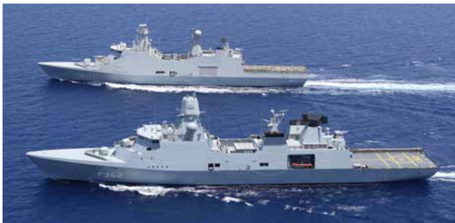
▲ Sammenlignet med ABSALON-klassen er IVER HUITFELDT-klassen et dæk lavere, 1,1 meter længere, 30 centimeter bredere og cirka 300 tons tungere. Her PETER WILLEMOES (forrest) og ESBERN SNARE i Middelhavet i maj 2014.
