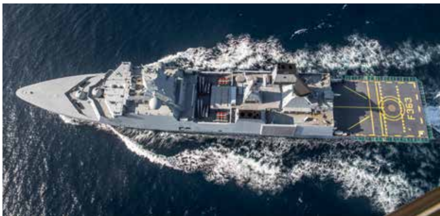
▲ NIELS JUEL. MK41-launcheren ses midtskibs. Ved siden af launcheren ses fire flexcontainere med Harpoon-sømålsmissiler og ESSM-luftmålsmissiler. (K. Brøndum)
