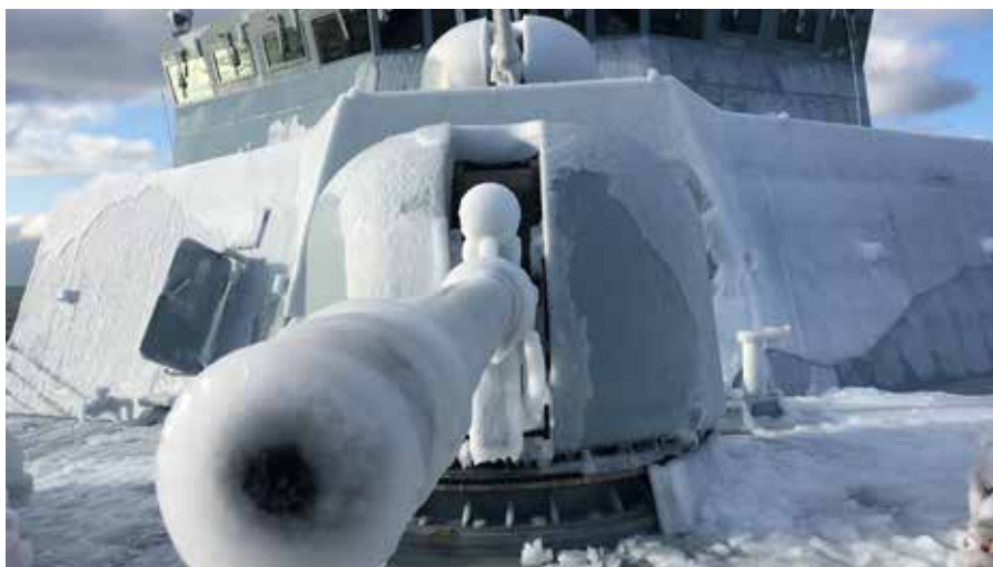
▲ Forsvarets øgede fokus på Arktis betyder, at en af fregatterne fremover kan forventes indsat i det arktiske område minimum 60 dage om året. Da fregatterne ikke er designet til operationer i disse områder, skal de passe på is - både i vandet og på skroget, hvor sidstnævnte kan påvirke skibets stabilitet og evne til at benytte våbensystemerne. Fregatternes indsættelse i det arktiske område forventes derfor fortrinsvis at blive i sommermånederne.
