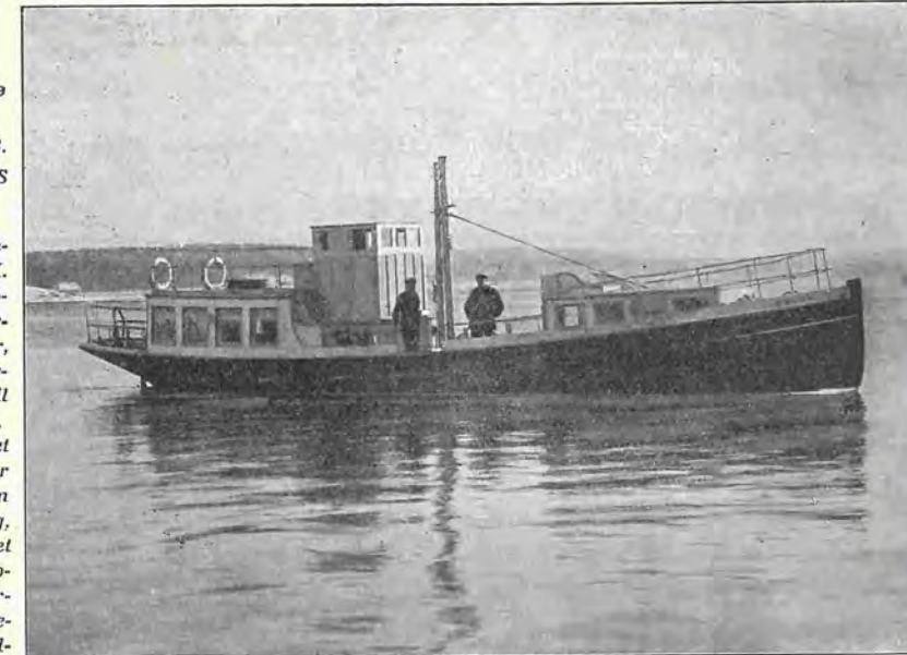
M/B „ECKMANN“ Færgebaad Svendborg—Thorsø. Beregnet for 135 Passagerer. Forsynet med en THORNYCROFT Model M/4 Motor med Reduce-Reverse Gear. Fart ca. 9 Knob.
